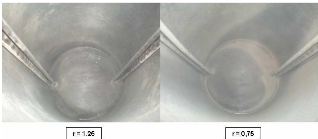
Figure IV.12 : photos de l'intérieur de la chambre après combustion de mélanges de particules ligno-cellulosiques de type AA et d'air de différentes richesses
