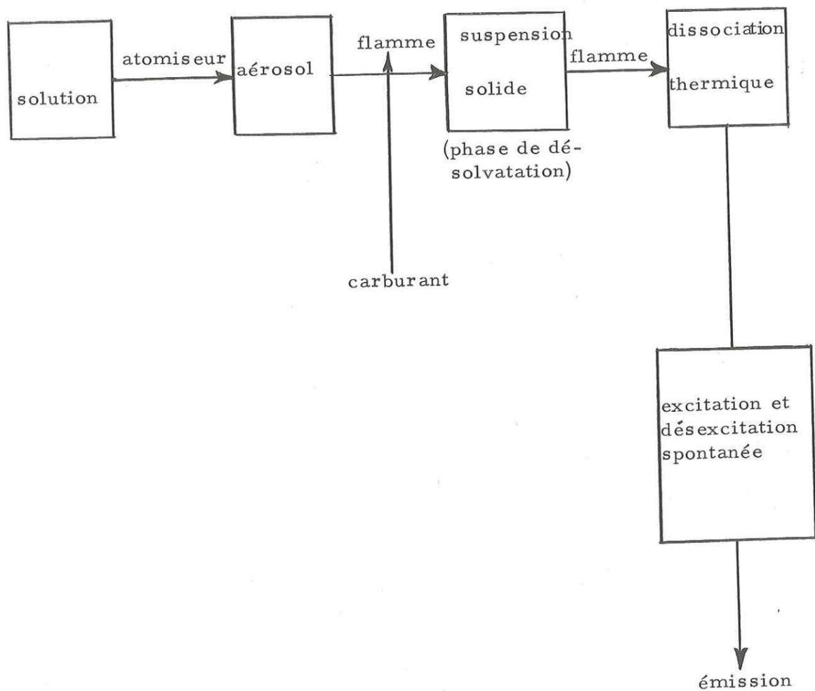
Fig. 17 bis - Schéma de l'appareil Varian Techtron
