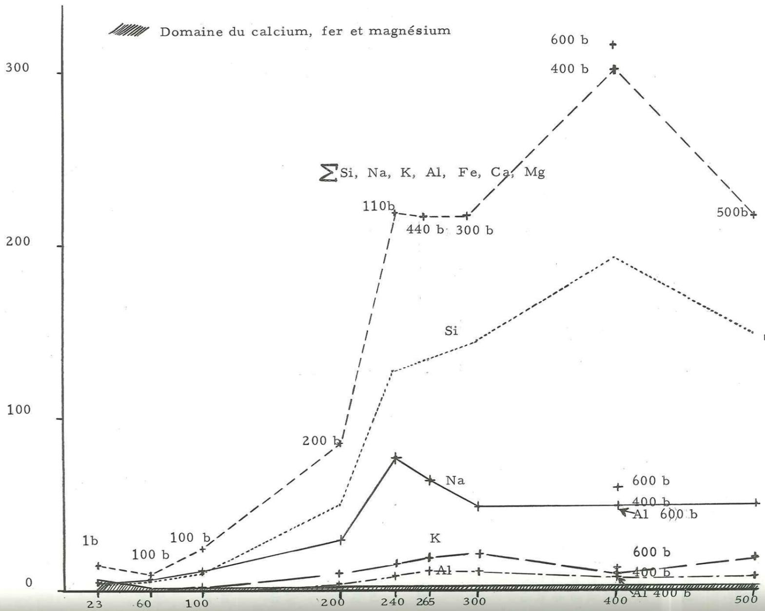
Fig. 25 - Diagramme de la concentration des éléments en fonction de la température (la P<sub>H2</sub>O est indiquée ci-dessous - - - - -)
