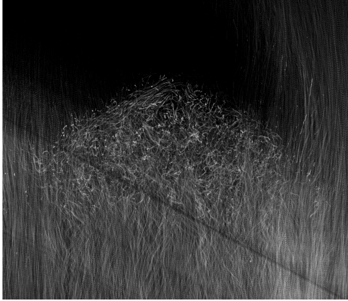
FIGURE 1 – Visualisation, à l’aide de particules, de l’écoulement autour d’une dune en forme de croissant ( barchane , forme sombre en haut). La recirculation créée à l’abri de la dune montre des trajectoires complexes à faible vitesse, tandis que l’écoulement extérieur présente des trajectoires quasi rectilignes et des vitesses beaucoup plus élevées.
