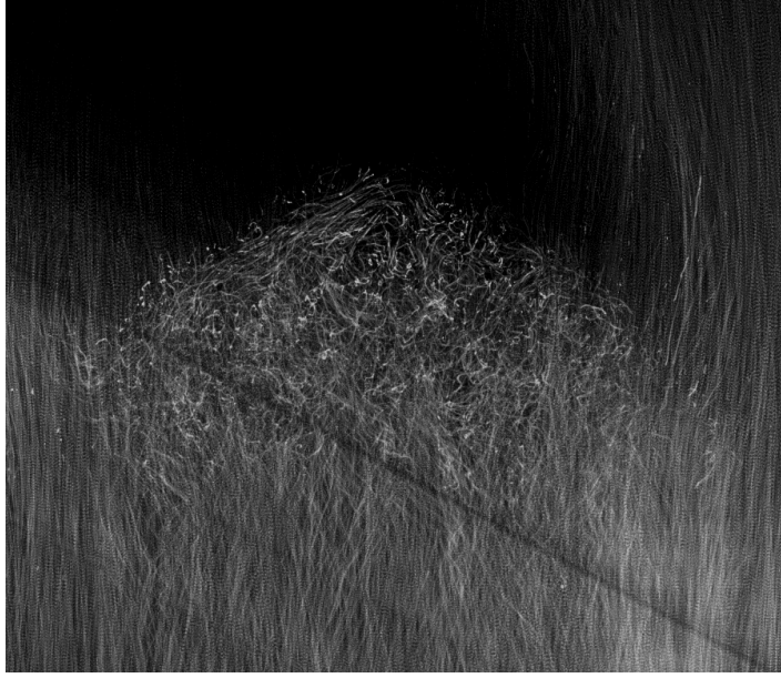
FIGURE 1 – Visualisation, à l’aide de particules, de l’écoulement autour d’une dune en forme de croissant ( barkhane , forme sombre en haut). La recirculation créée à l’abri de la dune montre des trajectoires complexes à faible vitesse, tandis que l’écoulement extérieur présente des trajectoires quasi rectilignes et des vitesses beaucoup plus élevées.
