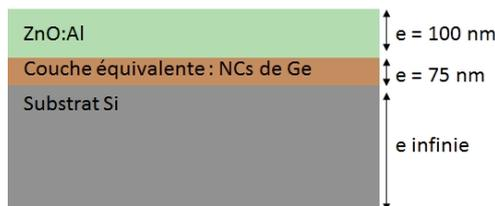
FIGURE 5.30 – Schéma de l'empilement de couches modélisé.
