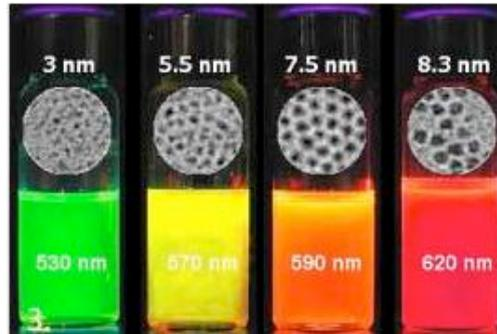
FIGURE 1 – Illustration de la luminescence de boîtes quantiques de CdSe /ZnS (sélénure de cadmium et de sulfure de zinc) de différentes tailles comprises. En modifiant la taille des ces boîtes quantiques, entre 3 et 8,3 nm, on fait varier leur longueur d’onde de luminescence entre 530 et 620 nm [4].
