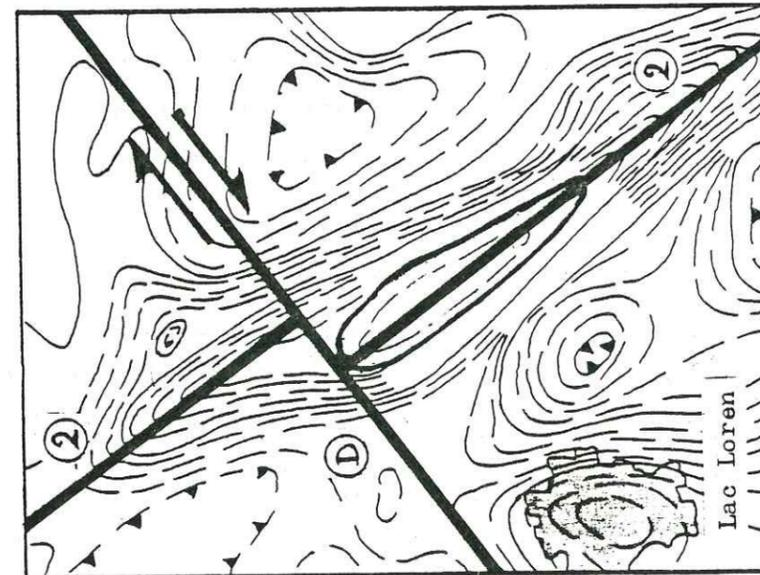
Fig. 67 - Anomalie magnétique induite par la fracture 2 et décalée par la fracture D.
