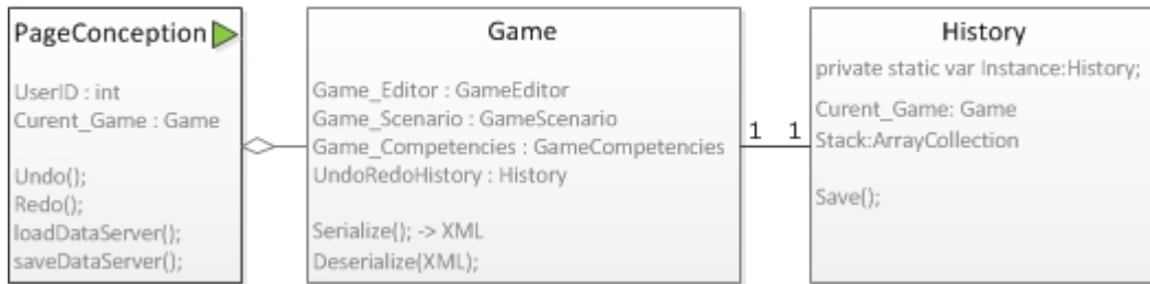
Fig 17 : Diagramme de classes pour les fonctionnalités de Undo Redo
