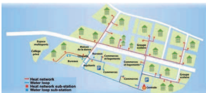
▶ Figure 9.7. Le réseau de chaleur de Ginko
