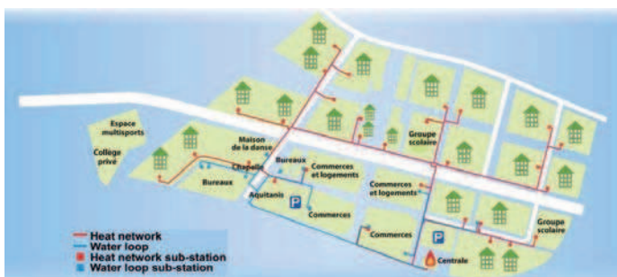
▶ Figure 9.7. Le réseau de chaleur de Ginko
