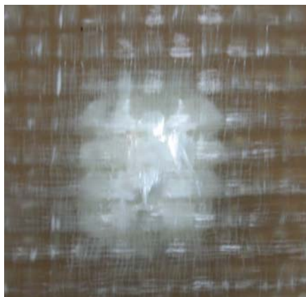
Figure VI-15 : Photo d'un impact de 50 Joules sur le composite VG.
