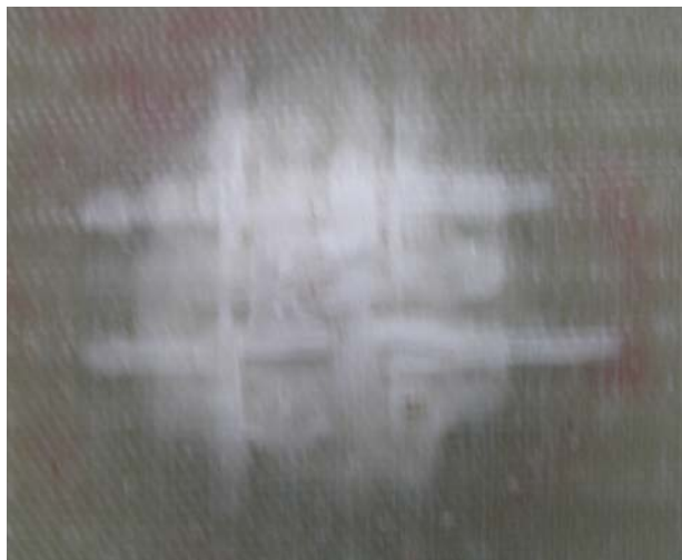
Figure V-26 : Photo d'un impact de 70 Joules sur un composite à renforts de fibres de verre.
