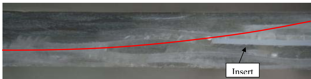
Figure III-17 : Photo d'une coupe transversale d'une plaque impactée à 15 J avec insert.
