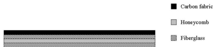
Figure I-6 : Structure carbone/ verre utilisé EUCLID RTP 3.21.
