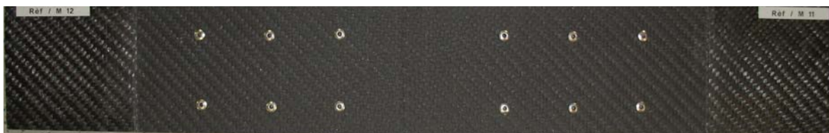
Figure IV-42 : Liaison hybride-carbone avec une zone de recouvrement de 200 mm avec rivets.
