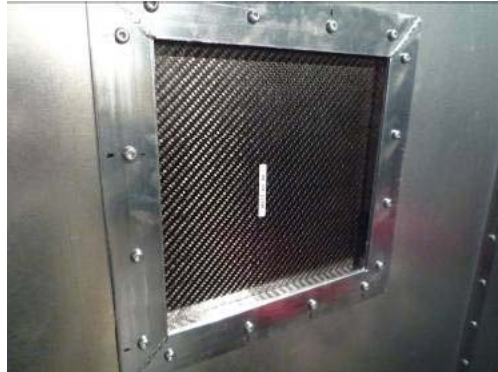
Figure II-16 : Plaque de matériau à mesurer installées sur profils et cadre.
