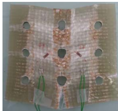
Figure II-15 : Photo de l’éprouvette après le cisaillement 3 rails.
