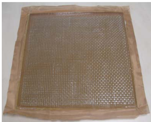
Figure IV-26 : Grillage Gantois sortant de la plaque verre pour assurer la continuité électrique.
