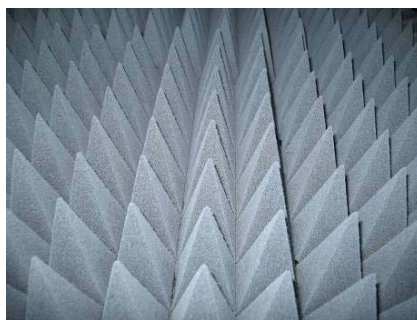
Figure II-18 : mousse de polyuréthane dans une chambre anéchoïque.
