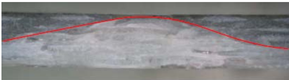
Figure III-16 : Photo d'une coupe transversale d'une plaque impactée à 15 J sans insert.
