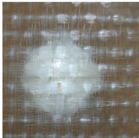
Figure VI-14 : Photo d'un impact de 30 Joules sur le composite VG.
