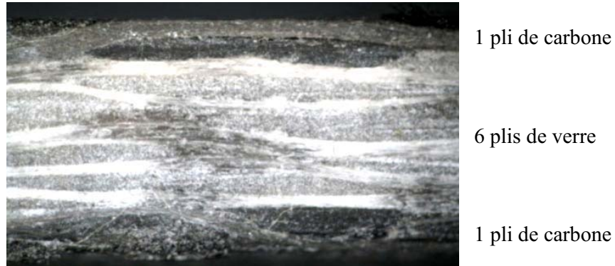
Figure IV-2 : Photo de la coupe transversale du matériau hybride Verre/Carbone.
