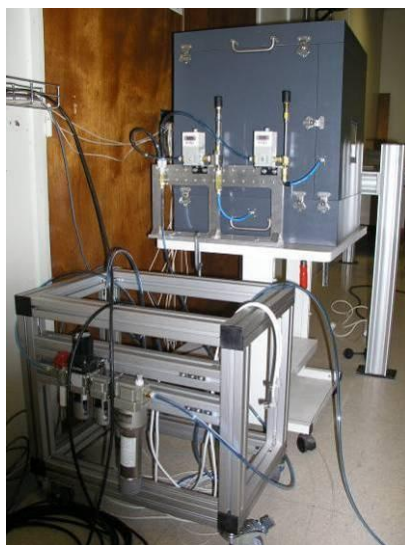
Figure 51 : Système de refroidissement par circulation d'air utilisant des tubes vortex. Au premier plan les différents filtres pour l'air comprimé du réseau, en amont des 2 régulateurs de pression et des 2 tubes vortex au second plan devant l'enceinte du calorimètre.
