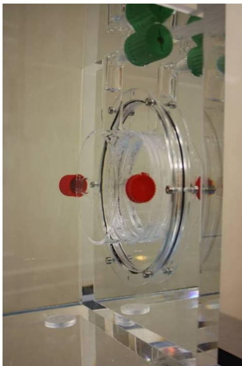
Figure 52 : Ampoule scellée remplie d'eau ultra-pure, encastrée dans la face avant du fantôme d'eau.
