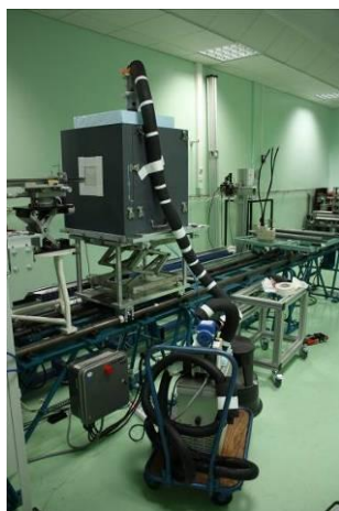
Figure 57: Système de descente en température « rapide » de l'eau du calorimètre, utilisant une pompe et une circulation d'eau dans la cuve du calorimètre.
