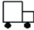
Figure 2.14 - Primitive désignant un transport entre l'entreprise et ses différents partenaires en VSM -
