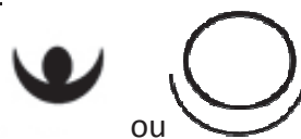
Figure 2.5 - Primitive de localisation d'un opérateur en VSM -
