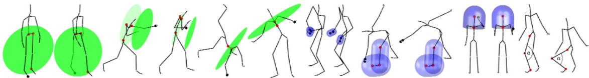
Figure 1.12 - Descripteurs qualifiant les relations géométriques entre différentes articulations (marquées par les points rouges et noirs) [Müller2005].
