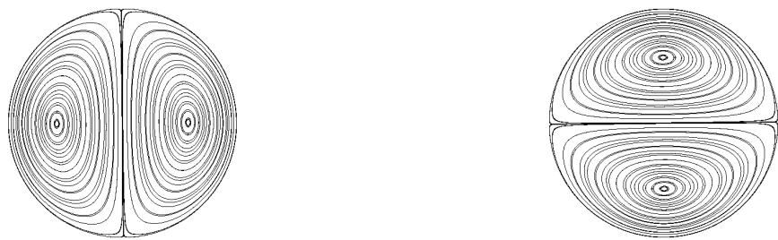
FIGURE 2.5 – Vecteurs propres dans le cas d'une seule particule
