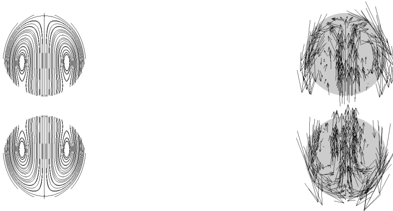
FIGURE 5.18 – Lignes de courant et champ de vitesse du contrôle dans le cas de deux particules proches après deux itérations
