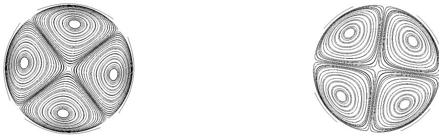
FIGURE 2.7 – Vecteurs propres dans le cas d'une seule particule
