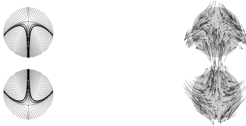
FIGURE 5.17 – Lignes de courant et champ de vitesse du contrôle dans le cas de deux particules proches après une itération
