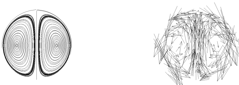
FIGURE 5.11 – Lignes de courant et champ de vitesse du contrôle dans le cas de deux particules éloignées
