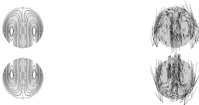
FIGURE 5.18 – Lignes de courant et champ de vitesse du contrôle dans le cas de deux particules proches après deux itérations
