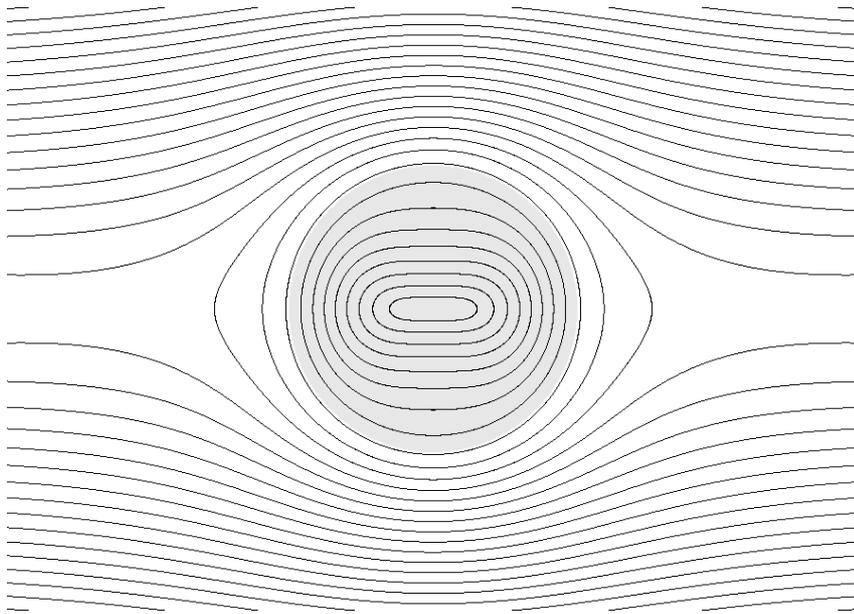
FIGURE 4.9 – Ligne de niveaux dans le cas d'une particule dans un champ cisailé
