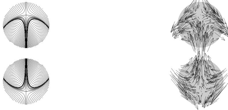
FIGURE 5.17 – Lignes de courant et champ de vitesse du contrôle dans le cas de deux particules proches après une itération
