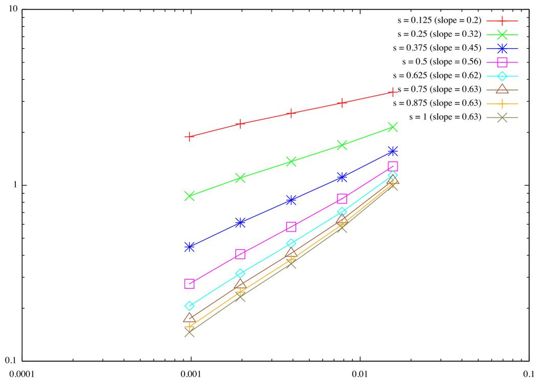
FIGURE 3.3 – Erreur  $H^1$  pour quelques valeurs de  $s$
