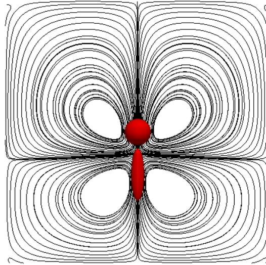
FIGURE 8.3 – Lignes de courant d'un pusher
