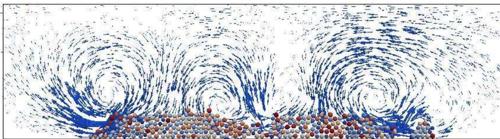
FIGURE 7.15 – Tas de sable avec contacts visqueux après 100 itérations en temps
