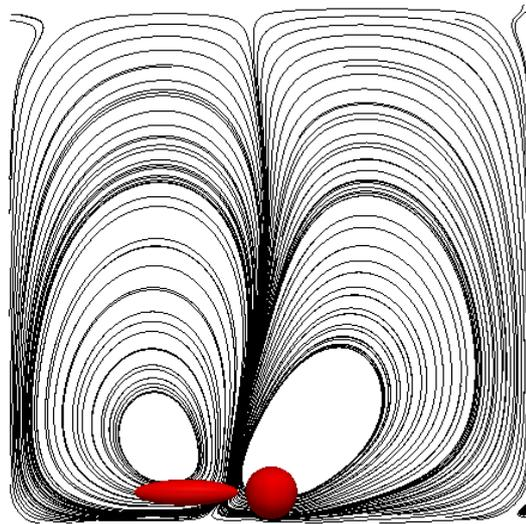
FIGURE 8.5 – Lignes de courant d'un pusher près d'un bord.
