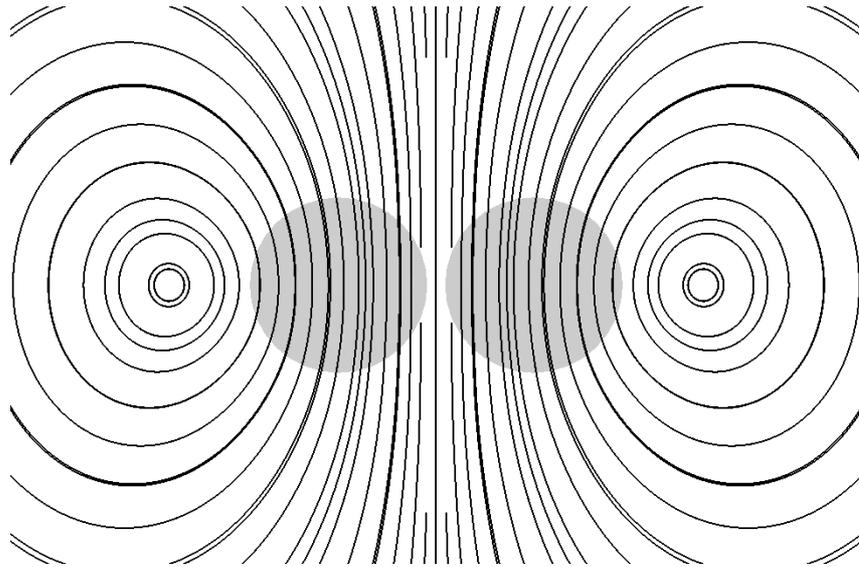
FIGURE 5.14 – Lignes de courant pour 2 particules proches
