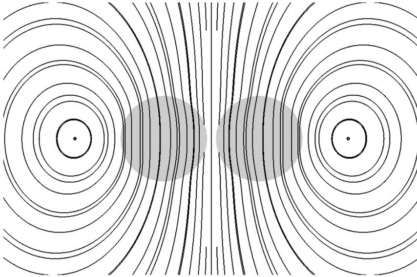
FIGURE 5.15 – Lignes de courant pour 2 particules rigides proches
