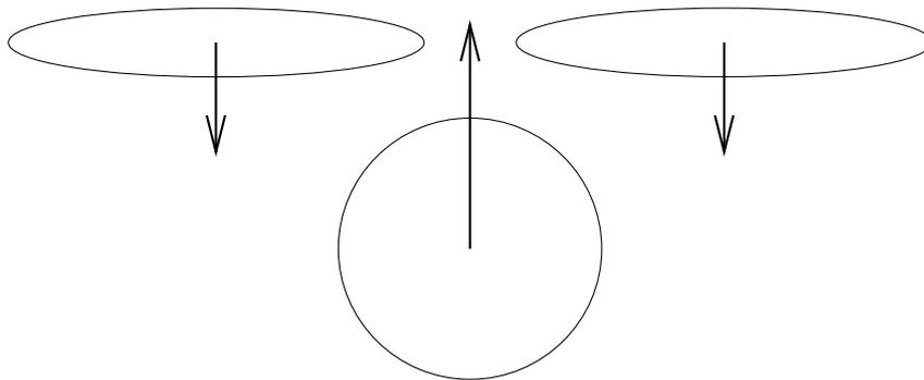
FIGURE 8.9 – Les forces pour un puller
