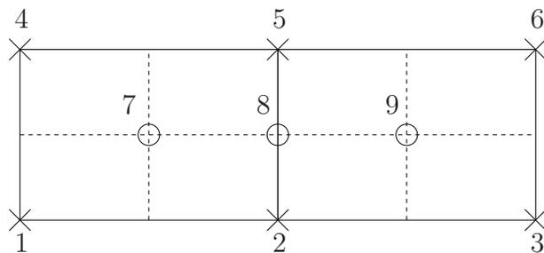
FIGURE 5.2 – Macro-élément constitué de deux cellules en pression
