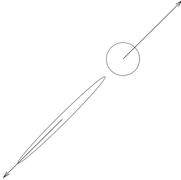
FIGURE 8.1 – Dipôle de force pour le pusher
