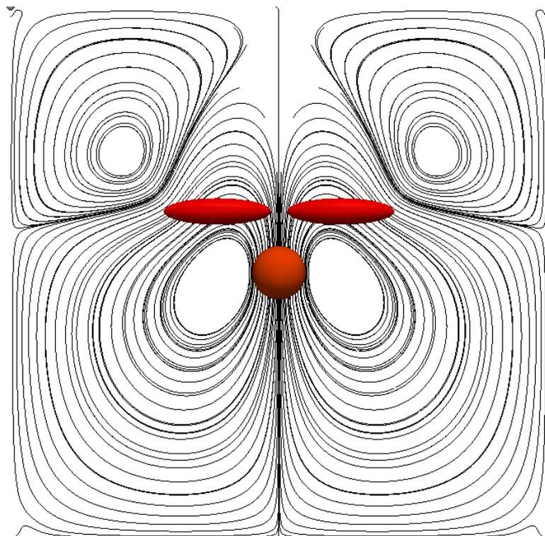
FIGURE 8.11 – Lignes de courant d'un puller
