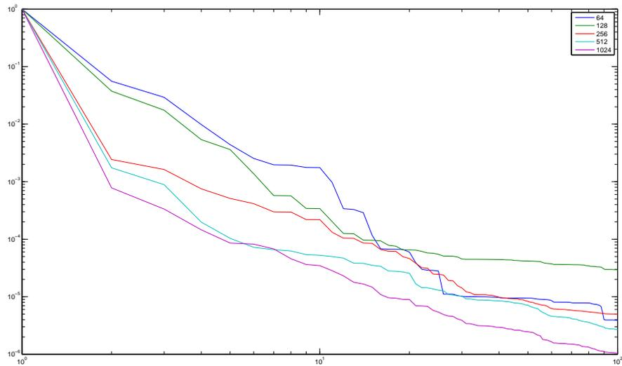
FIGURE 5.5 – Évolution du résidu pour différents pas de maillage et une erreur de  $10^{-6}$  sur le solveur de Stokes
