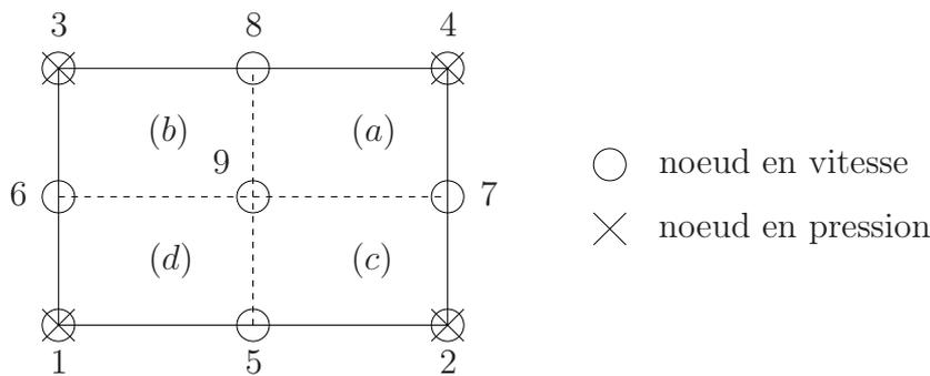
FIGURE 5.1 – Macro-élément constitué d'une cellule en pression
