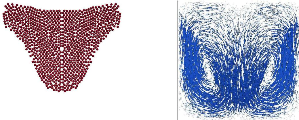
FIGURE 7.3 – Sédimentation après 40 itérations en temps
