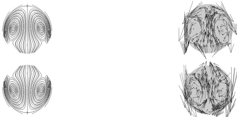
FIGURE 5.19 – Lignes de courant et champ de vitesse du contrôle dans le cas de deux particules proches après dix itérations
