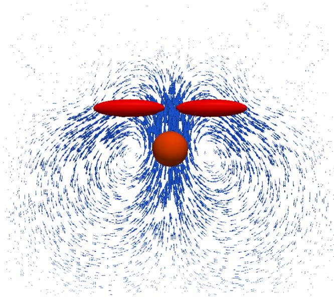
FIGURE 8.10 – Champ de vitesse d'un puller
