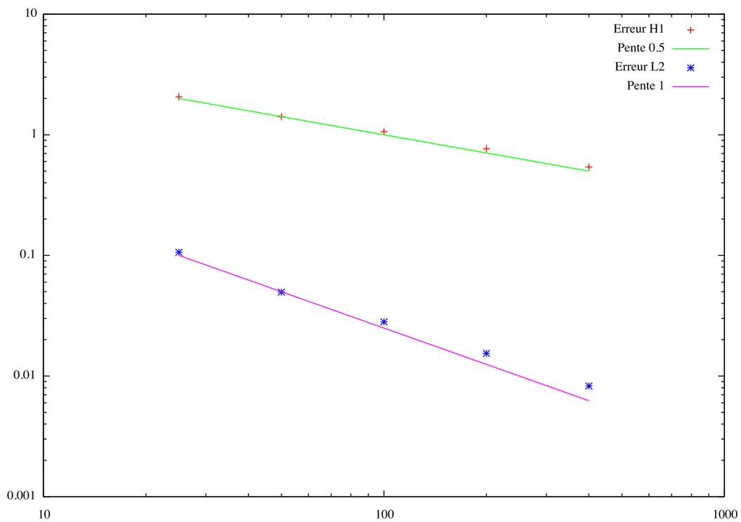
FIGURE 1.5 – Erreur en norme  $H^1$  et  $L^2$  pour la méthode de pénalisation
