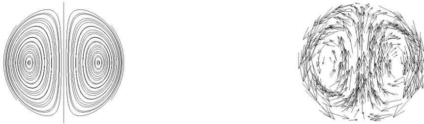
FIGURE 5.10 – Lignes de courant et champ de vitesse du contrôle dans le cas d'une particule seule
