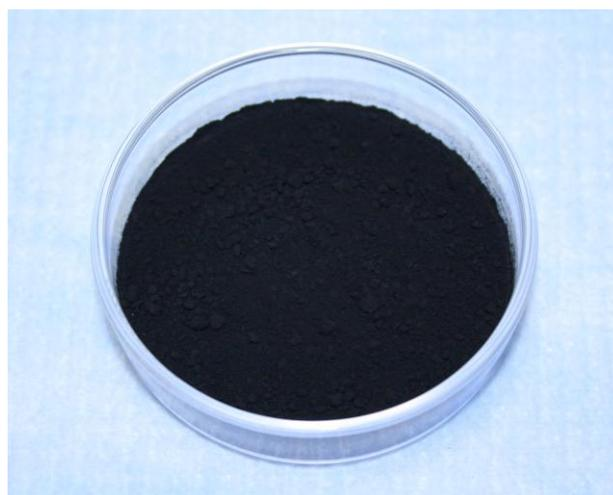
Figure III-12 : Piégeur classique  $MnO_2/Ag_2O$  à 13% massique en  $Ag_2O$
