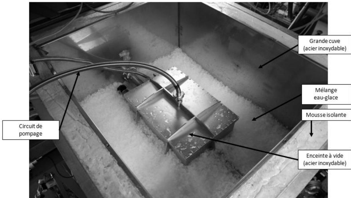
Figure II-3 : Vue du dessus de l'enceinte à vide placée dans la grande cuve remplie d'un mélange eau-glace.
