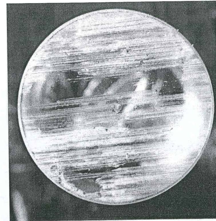
Figure 8.1. Epreuve de glace après essai de frottement. Rainures laissées par le passage des aspérités de la plaque de béton sur la glace. Diamètre de l'éprouvette : 6 cm. Essai p010051, \sigma_n = 50 \text{ kPa} , V_e = 0,1 \text{ mm.min}^{-1} , R_a = 0,10 \text{ mm} , 7 cycles.
