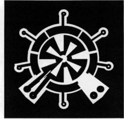
b) Enroulements diphasés et capteur capacitif intégré
