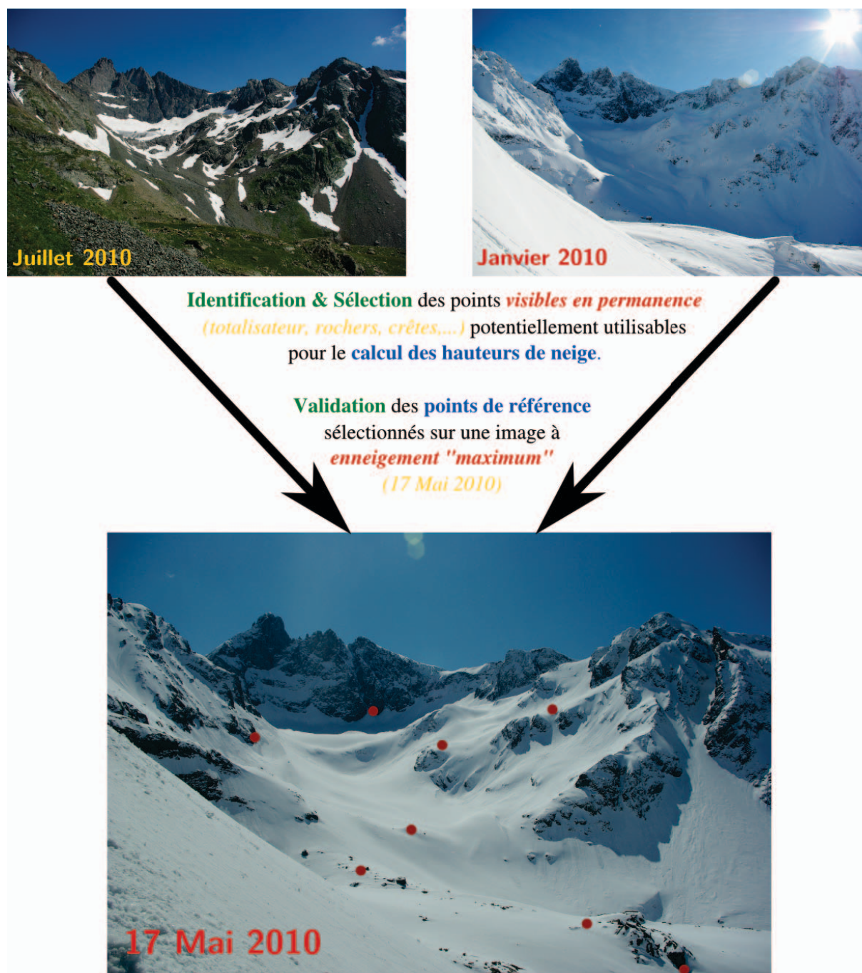
FIG. 10.1: Sélection des points de références potentiels pour la détermination de l'épaisseur du manteau neigeux
