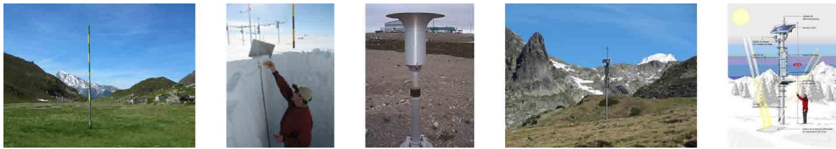
FIG. 2.3: Instruments de mesures nivologiques :1-Perche à neige et sondage 2-Nivomètre 3-Sonde à ultrasons 4-Télénivomètre à rayonnement cosmique
