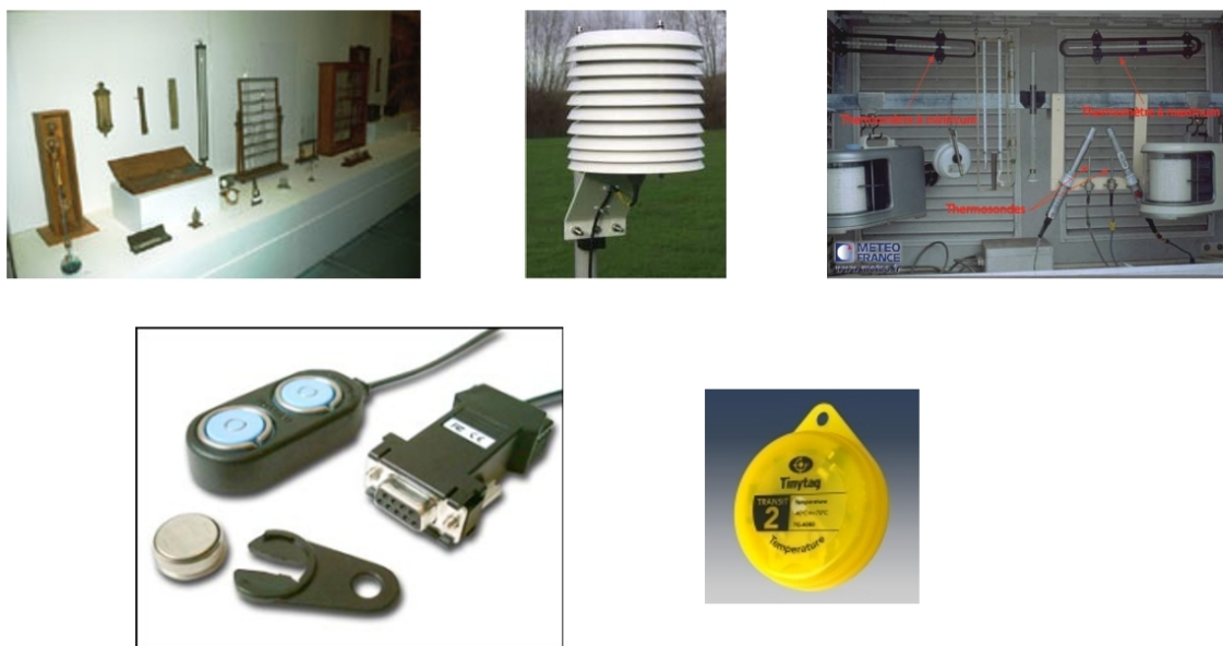
FIG. 2.4: Des premières mesures de la température aux capteurs miniatures : 1-Thermomètres anciens (Thermomètre à bulles, Antonini, 1612) 2-Sonde et capsule de protection 3-Thermomètre classique MétéoFrance 4-iButton 5-TinyTag
