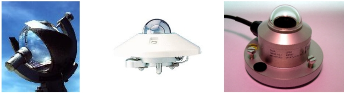
FIG. 2.5: Instruments de mesure de l'insolation : 1-Héliographe 2-Pyranomètre 3-Pyranomètre (Campbell)
