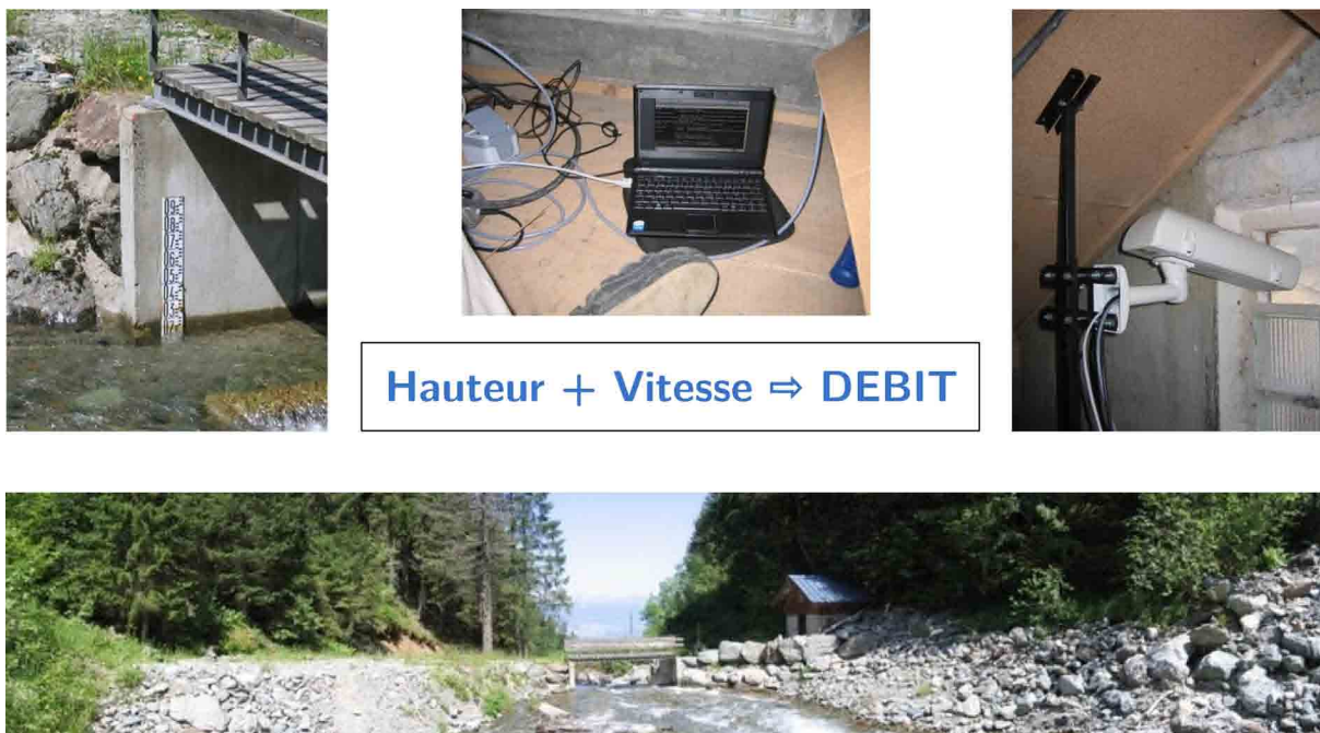
FIG. 3.22: mesure du débit par le capteur IMAGE
