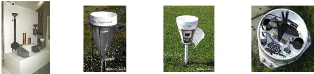
FIG. 2.2: Des premiers instruments de mesure de la pluie aux pluviomètres à augets modernes :1-Pluviomètre ancien Mangon.H (fin XIX ème ) 2-Pluviomètres à lecture manuelle 3-Pluviomètre à enregistreur 4-Pluviomètre à augets basculants
