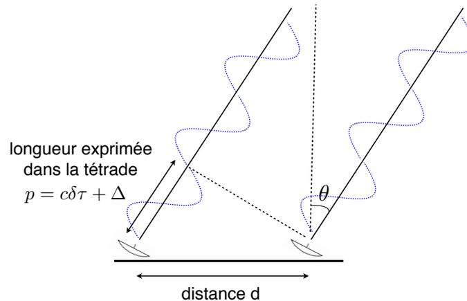
FIGURE 2.2 – Schéma représentant les observations VLBI. La quantité mesurée est la différence de temps propre  $\delta\tau$  entre la réception du même signal par deux stations différentes. Cette quantité mesurée est ensuite interprétée en terme d’une direction d’arrivée du signal observé dans un référentiel local.
