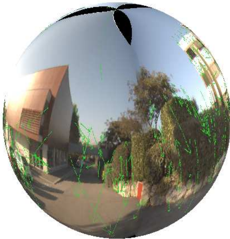
FIG. 3.4 – Exemple de vue sphérique avec projection des points d'intérêt SIFT sur la surface de la sphère. Les points SIFT sont les mots visuels considérés dans cette approche.
