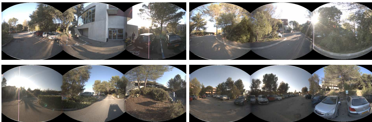
FIG. 4.7 – Quelques fausses fermetures de boucle détectées par l’algorithme. L’image de gauche est l’image courante tandis que l’image de droite est la fausse fermeture de boucle détectée.
