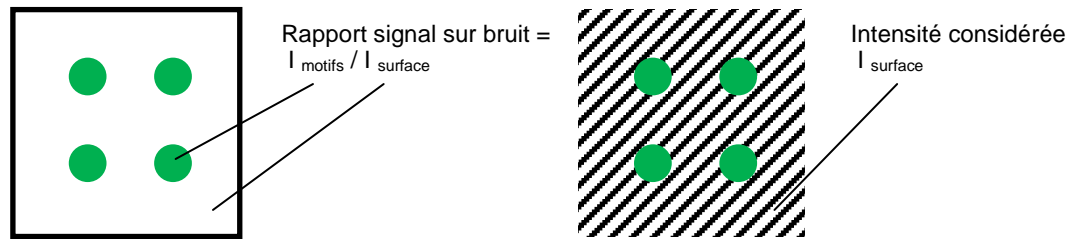
Figure 25 : Le calcul du rapport signal/bruit se fait en considérant l'intensité des plots et celle du fond continu de l'échantillon. Le calcul effectué pour cette expérience ne tient compte que de l'intensité du fond continu (zone hachurée) et pas de l'intensité des plots.
