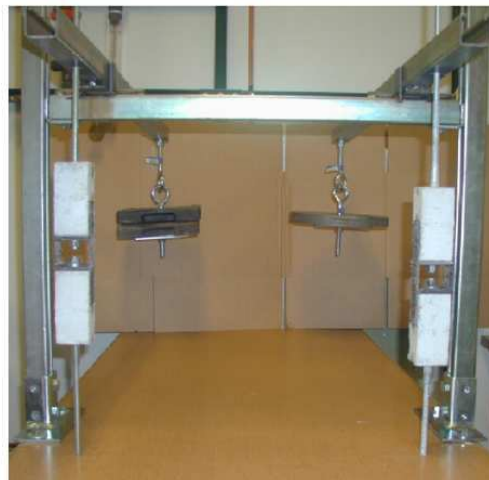
Figure I-32 Dispositif à potence pour la sollicitation de fluage de l'interface collée béton/FRP – corps d'épreuve à deux blocs (d'après [CHO 07]).
