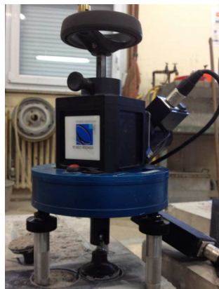
Figure IV-27 Réalisation de l'essai de traction/arrachement du renfort collé.
