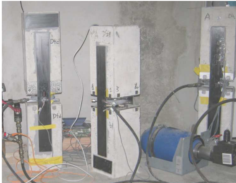
Figure III-26 Prototype du banc de fluage sollicitant 3 corps d'épreuves.
