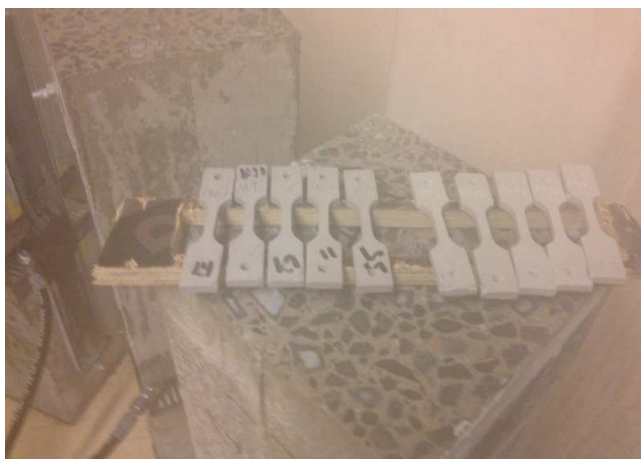
Figure IV-16 Echantillons de deux systèmes d'adhésifs (Sikadur 30 et Etacol 492) stockés dans la salle de vieillissement et destinés aux essais de prise de masse.
