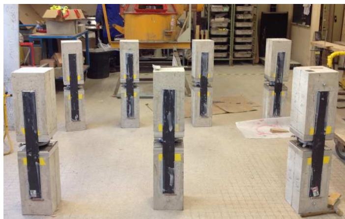
Figure IV-3 Corps d'épreuves à double recouvrement réalisés en utilisant le procédé de renforcement Compodex® .
