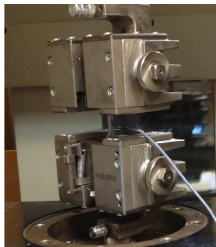
Figure IV-18 Epreuve placée dans les mors de la machine ZWICK.
