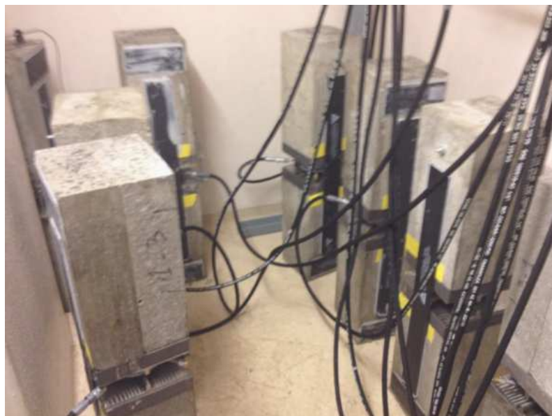
Figure IV-8 Banc de fluage en fonctionnement dans la salle de vieillissement du DLA.
