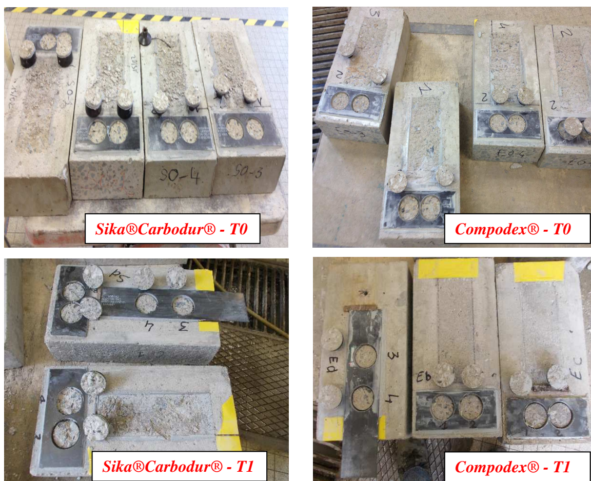
Figure IV-29 Evolution des modes de rupture des interfaces collées dans le cadre des essais de pastillage à T0 et T1
