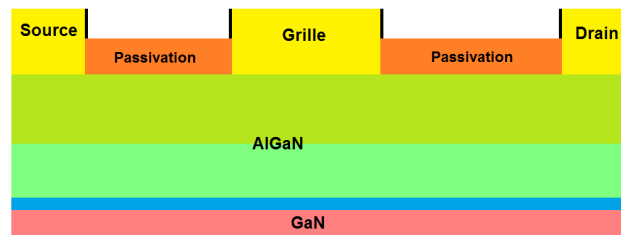
FIGURE 1.42 – Couche de passivation permettant de limiter les courants de fuite de grille et l'influence des pièges de surface.
