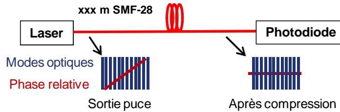
Fig. 5.33. Principe de la compression d'impulsion.
