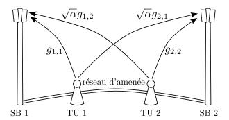
Figure 1: Illustration de modele de système: Deux stations de base reliées par un réseau de transport de capacité infinie décodent conjointement les messages des deux TUs.
