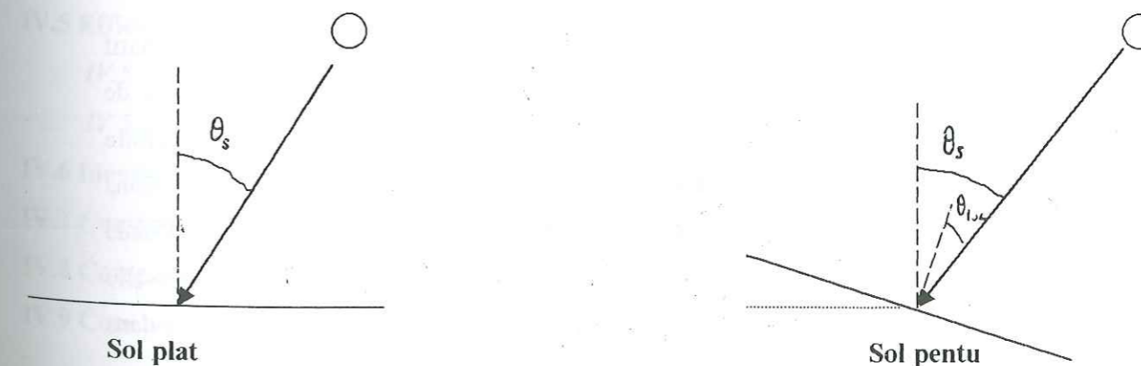
Figure III.9 : Schéma illustrant les différences entre les angles \theta_s et \theta_{loc} pour un sol non plat
