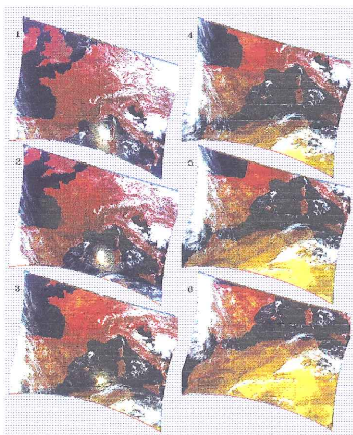
Figure II.1 : Séquence de 6 vues successives prises par POLDER lors de sa première campagne de tests le 16 septembre 1996 (Source : CNES). Images composites : 443nm en bleu + 670nm en vert + 865nm en rouge.
