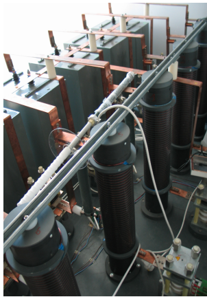
FIGURE 2.6 – A gauche, photographie des modules d'un générateur BMV. On distingue derrière les condensateurs (parallélépipèdes), les bobines cylindriques de protection et au premier plan un des thyristors. A droite, schéma du circuit électrique comprenant la bobine de l'expérience et le générateur. Celui-ci est composé de plusieurs modules de condensateurs que l'on décharge via la commande d'un thyristor dans la bobine. La diode crowbar empêche l'inversion du courant et la recharge des condensateurs.
