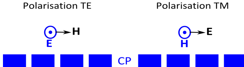
Figure 3.2: Définition de la polarisation de la lumière incidente (CP membranaire vu en coupe transverse).
