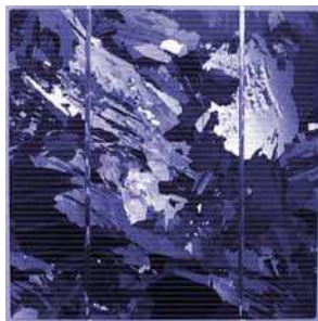
(b) Cellule photovoltaïque polycristalline. Source : http://pamiers.soleilentete.com
