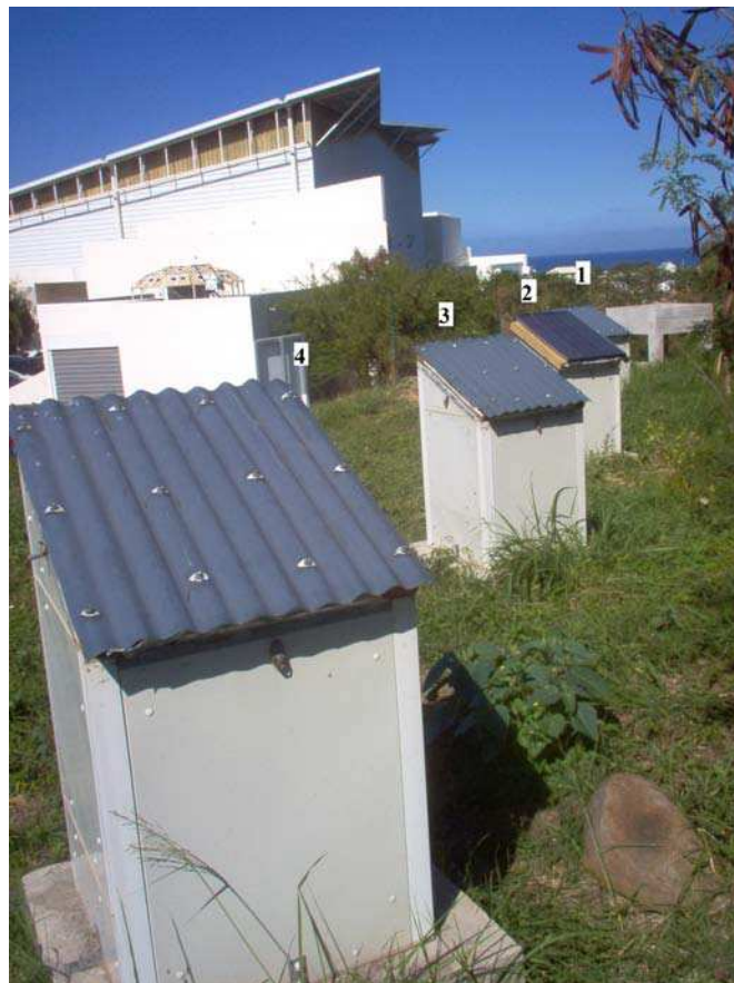
FIGURE III.5 : Prise de vue des quatre bâtiments à échelle réduite (ISOTEST).
