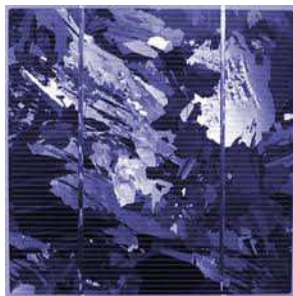
(b) Cellule photovoltaïque polycristalline. Source : http://pamiers.soleilentete.com
