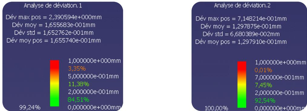
Analyse de la déviation pour la surface (a-1). Analyse de la déviation pour la surface (b-1).
