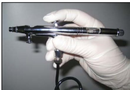
Figure 2 : photographie du système utilisé pour la pulvérisation de NTCs, de marque « Mecafer », modèle « AG4 ».
