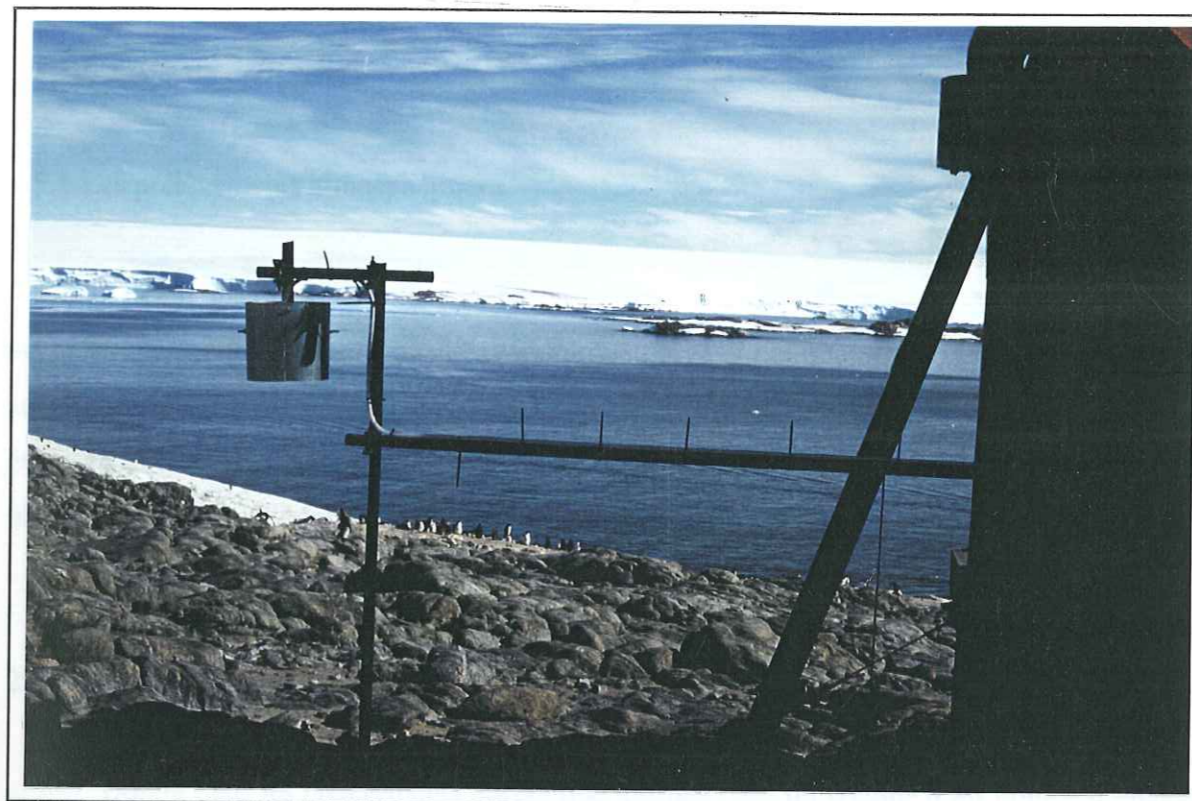
Photo 2.1: Le mât de prélèvement utilisé pour la collecte des aérosols.
