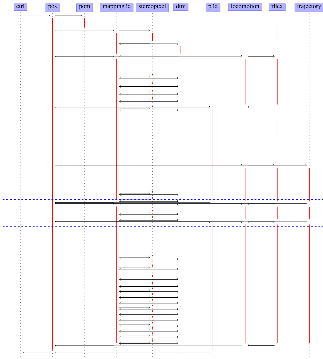
FIGURE 5.9 – Chronogramme d'un cas d'échec d'exécution pour une mission de navigation utilisant la stratégie 3D, puis d'utilisation d'une solution locale. Correspond à environ 30 secondes de mission.
