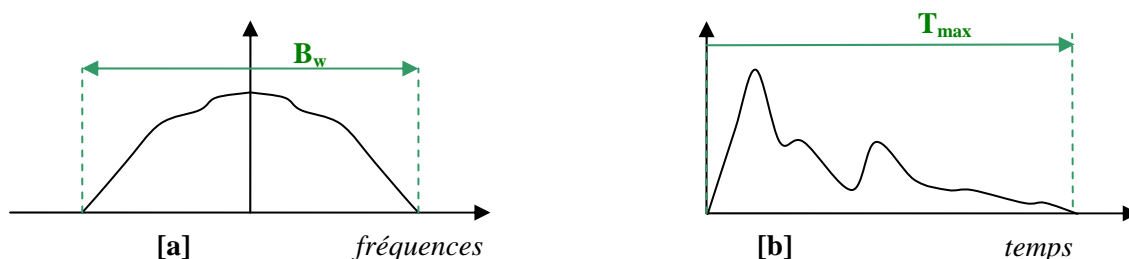
Figure III.4 : Illustration d'un signal de bande passante et de bande de cohérence quasi finies
