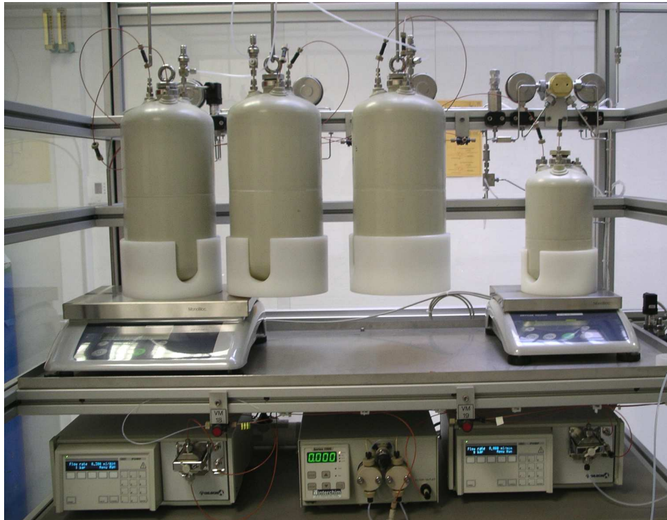
Figure II-2 : Photographie des réservoirs de solution et des pompes de chromatographie
