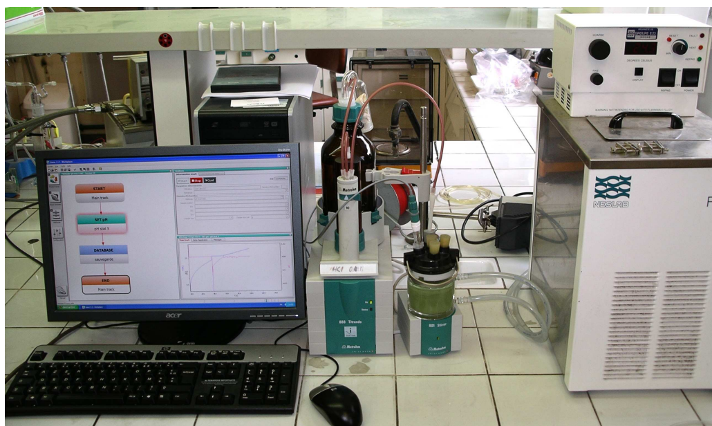
Figure V-10 : Photographie du dispositif expérimental de mesure de la vitesse de dissolution par la méthode du pH stationnaire
