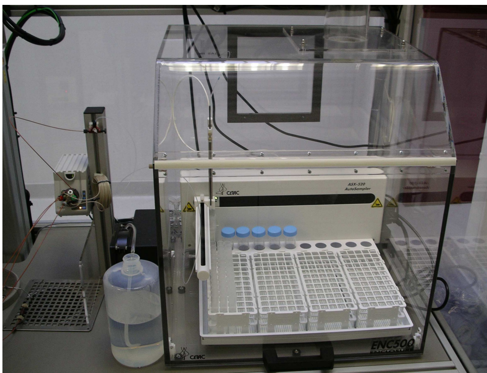
Figure II-7 : Photographie du circuit d'échantillonnage (sans la pompe de chromatographie)
