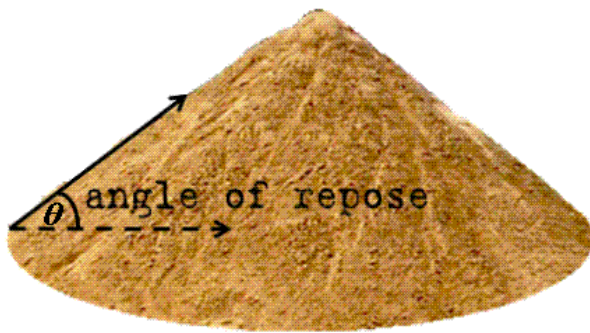
Figure 6. Tas de sable indiquant l'angle de repos.
