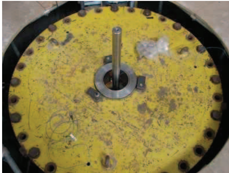
FIG. 3.7 – La pièce mécanique fixée sur le plateau supérieur
