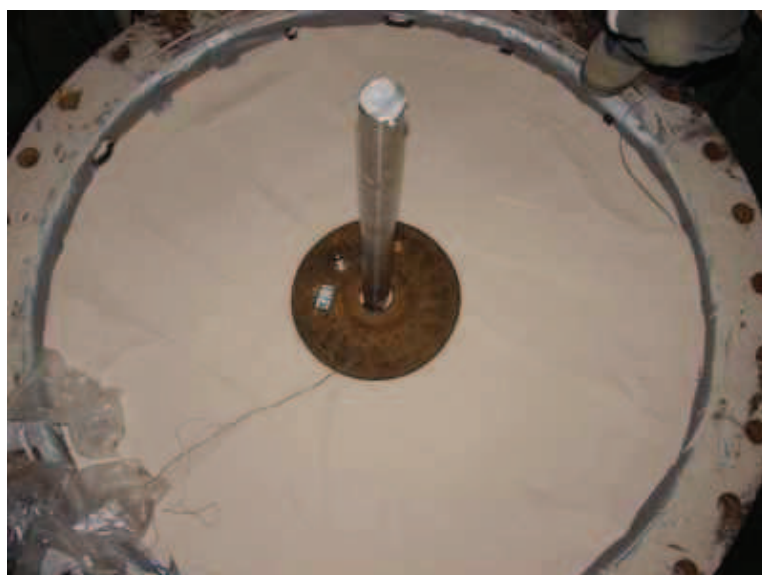
FIG. 3.6 – La petite membrane appliquant l'effort vertical à la fondation
