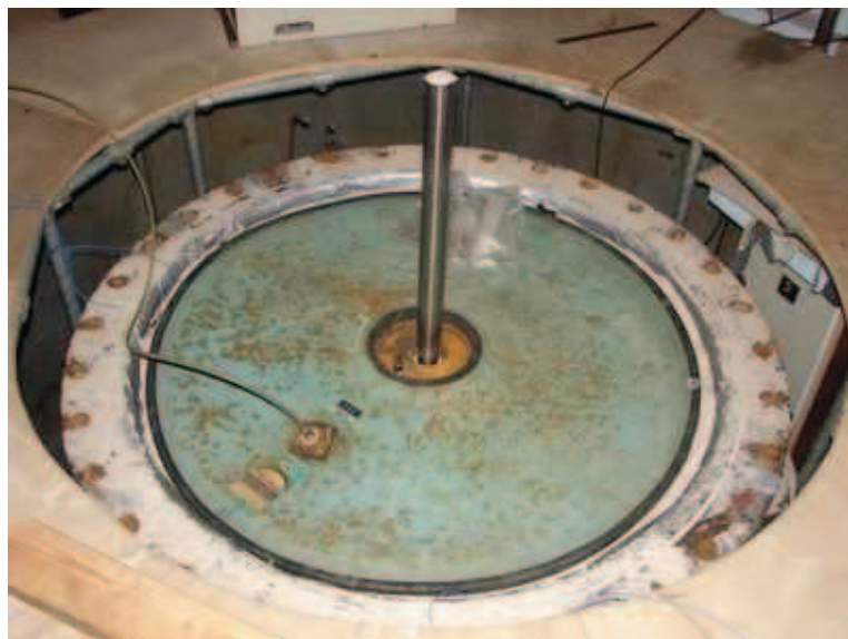
FIG. 3.5 – La membrane supérieure de la chambre d'étalonnage
