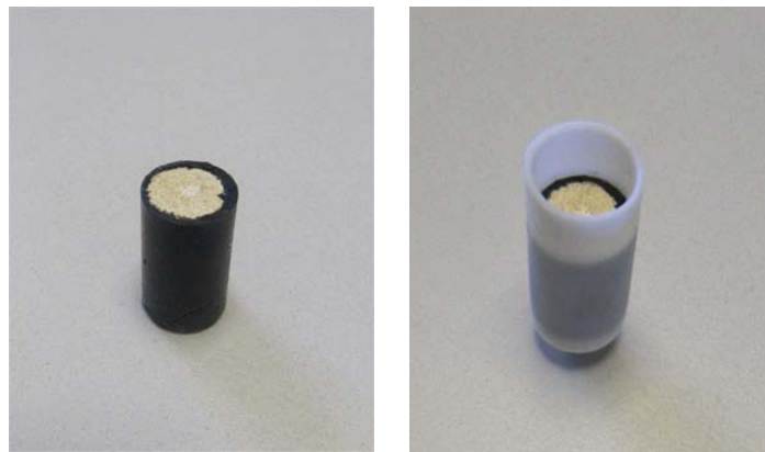
Figure 7.9. Photographie d'un échantillon siliconé (à gauche) puis placé dans la jaquette (à droite).
