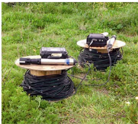
Figure 4.9. Sondes multi-paramètres Greenspan d'Hydreka avec 100 m de câble et un boîtier d'enregistrement muni d'une batterie (boîtes noires).
