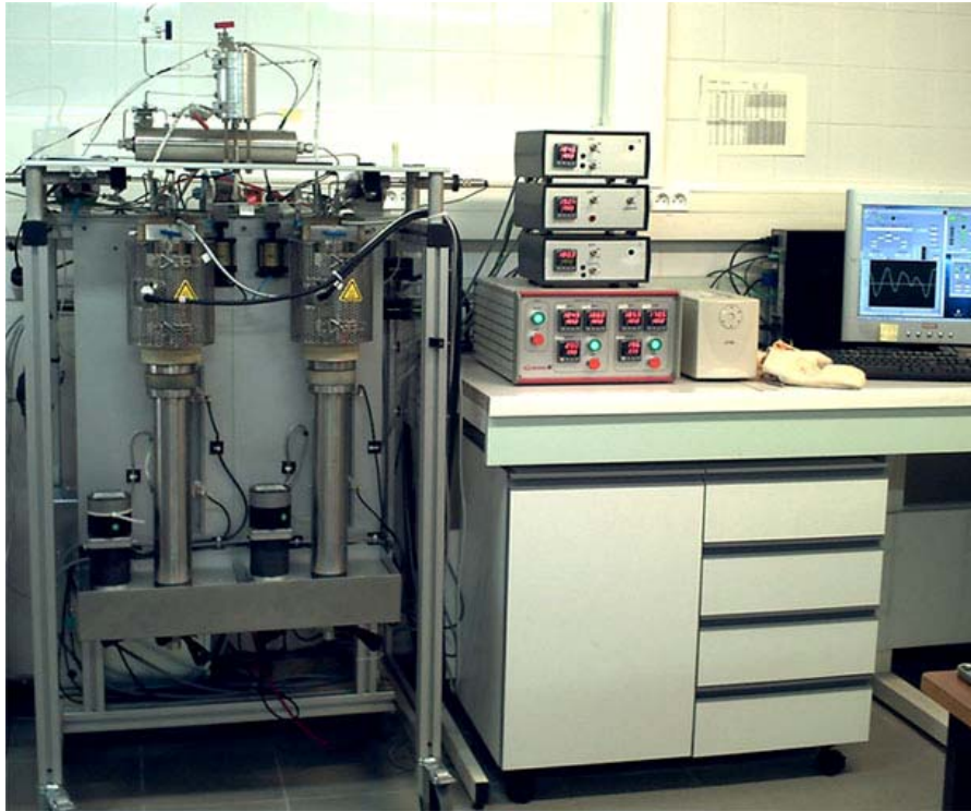
Figure 5.5. Photographie du banc expérimental ICARE-MicroLab utilisé pour réaliser les mesures de perméabilité
