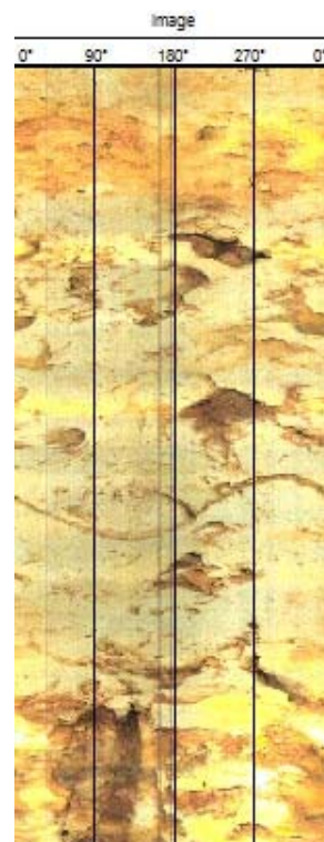
Figure 4.5. Exemple d'image optique de paroi de puits enregistrée avec l'outil OBI40 dans le puits MC2 entre 55 et 57 m de profondeur.
