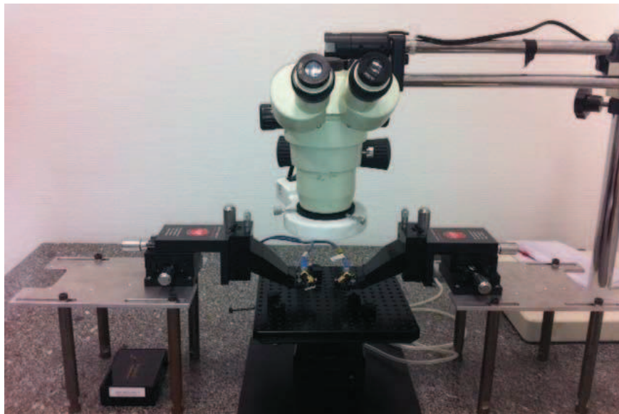
Figure III-20 – Banc de mesure sous pointe
