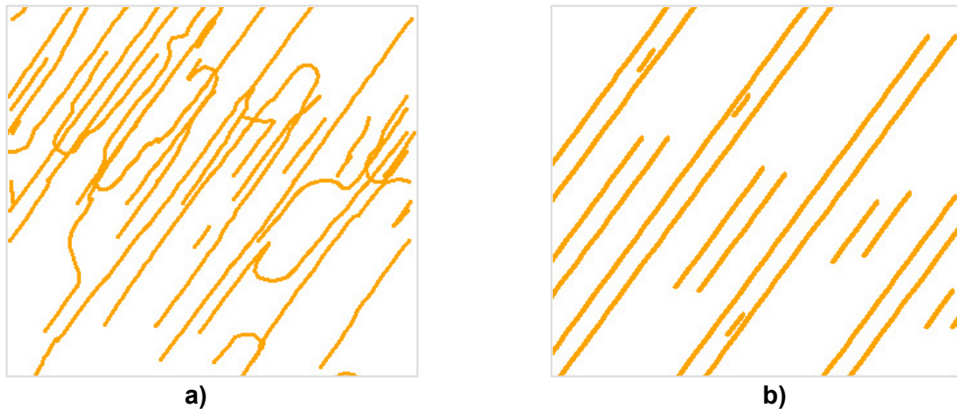
Fig. V-19 : Microstructures de dislocations déformées en cisaillement simple à contrainte imposée : a) 33MPa à 300K ; b) 160 MPa à 110K. La configuration est similaire à celle utilisée dans l'étude de la contrainte d'écoulement mais avec un nombre réduit de sources initiales.
