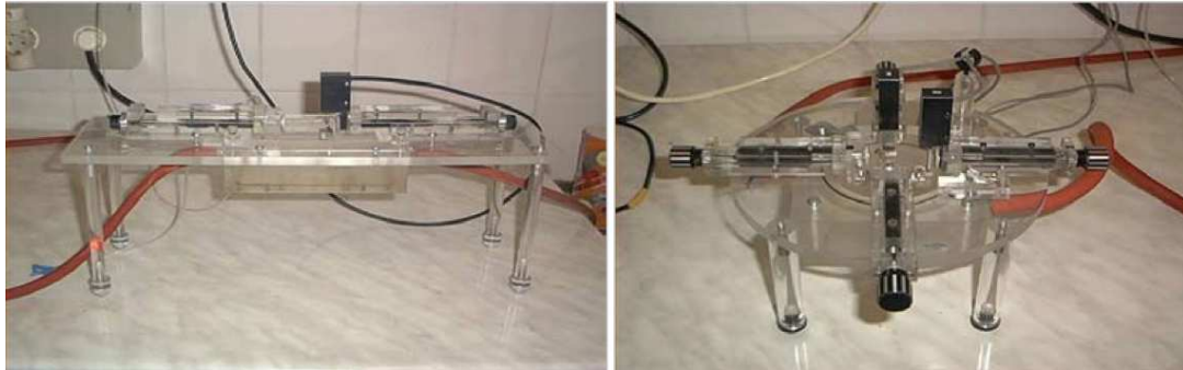
FIGURE 2.1 – Les machines de test uniaxial et biaxial(Toth et al [65]).
