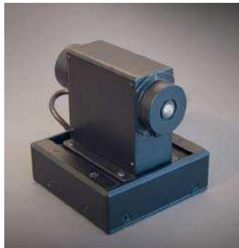
FIG. 7.3 – Cellule de Golay. La cellule de Golay que nous avons utilisé durant les travaux est vendue par MicroTech Instruments [94], figure 7.3. Les paramètres du détecteur sont reportés au tableau 7.1.
