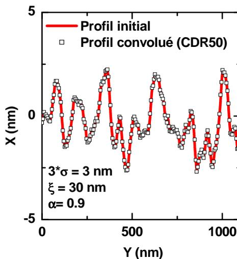
FIGURE III.21 – Allure d'un profil de rugosité avant (courbe rouge) et après (pointillés) convolution par une pointe de diamètre de  $50 \text{ nm}$ . Le même intervalle de mesure de  $5.5 \text{ nm}$  a été utilisé dans les deux cas.
