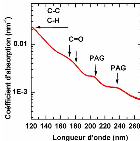
FIGURE IV.5 – Spectre d'absorption de la résine 193 nm
