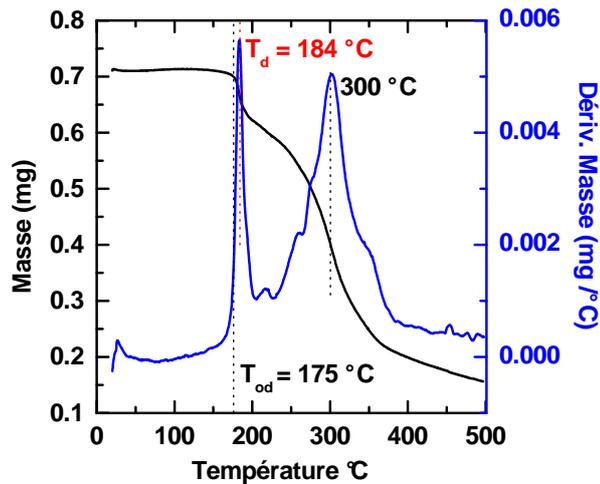
FIGURE II.4 – Thermogramme DMA de la résine 193 nm IM5010.
