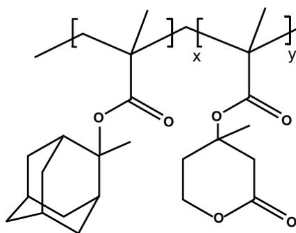
FIGURE I.17 – Résine 193 nm AZ/Clariant.
