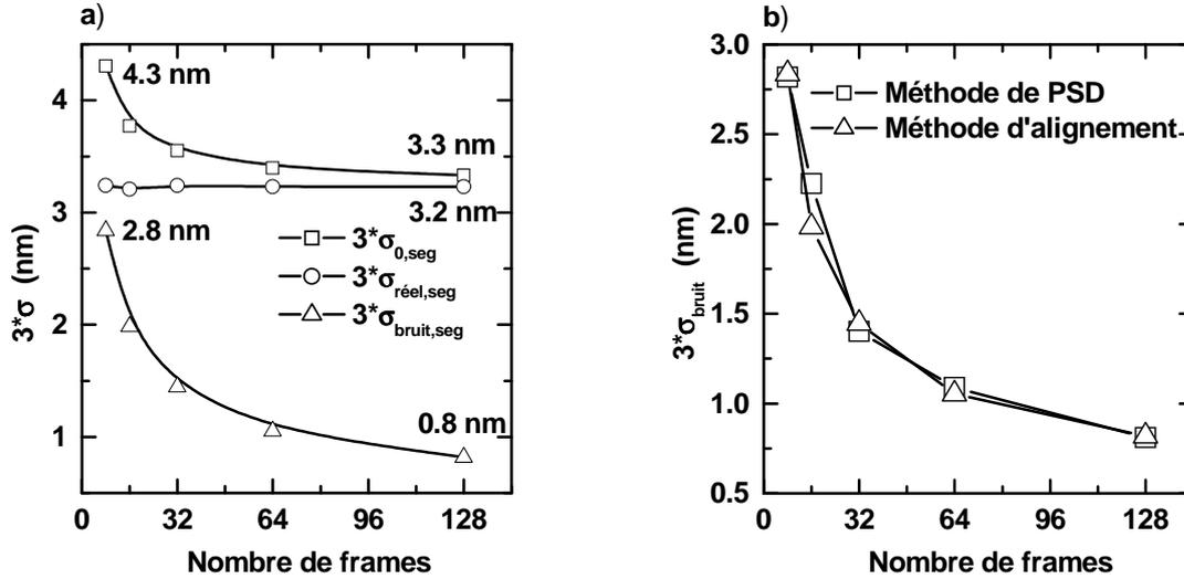
FIGURE III.28 – a) Variation de  $3\sigma_{0,seg}$ ,  $3\sigma_{réel,seg}$  et  $3\sigma_{bruit,seg}$  obtenus sur une ligne de silicium et calculés par la méthode d'alignement en fonction du nombre de frames. b) Comparaison des bruits obtenus sur silicium à partir des méthodes d'ajustement de PSD ( $3\sigma_{bruit}$ ) et d'alignement à différents nombres de frames ( $3\sigma_{bruit,seg}$ ).
