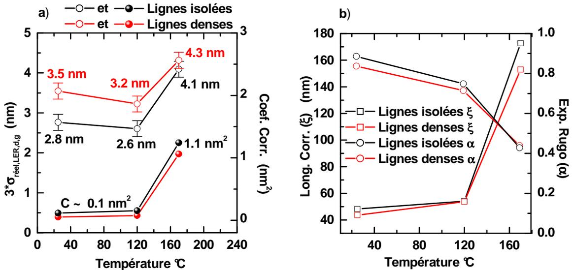
FIGURE V.25 – Evolution de a)  $\sigma_{\text{réel,LER,d,g}}$ , du coefficient de corrélation  $C$  et b) de la longueur de corrélation ( $\xi$ ) et de l'exposant de rugosité ( $\alpha$ ) du LER, des résines exposées au plasma  $\text{H}_2$ , en fonction de la température de recuit.
