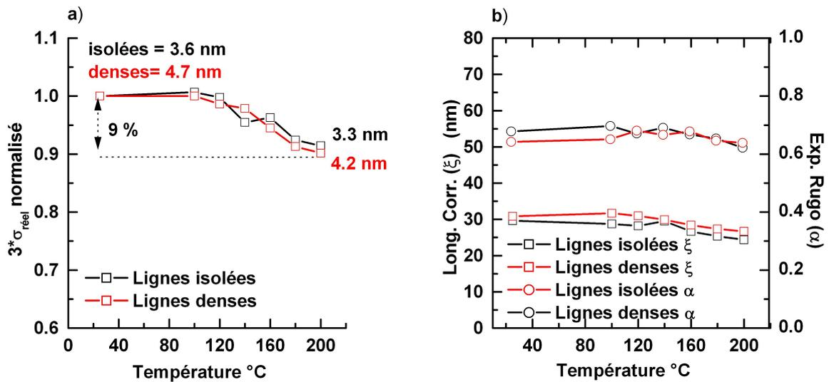
FIGURE V.15 – Evolution a) du LWR normalisée et b) de la longueur de corrélation ( $\xi$ ) et de l'exposant de rugosité ( $\alpha$ ) de la résine exposée au plasma HBr, en fonction de la température de recuit.
