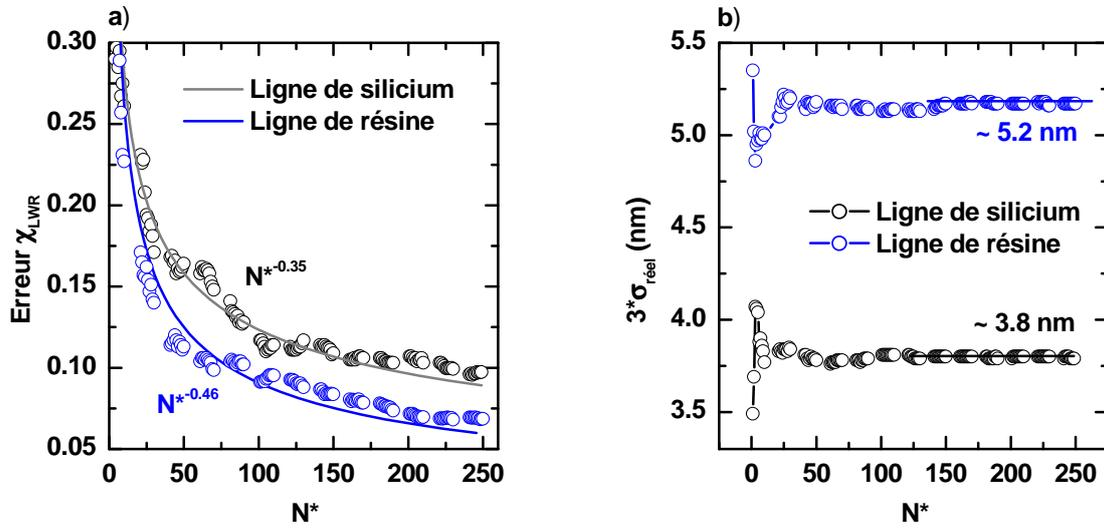
FIGURE B.1 – a) Erreur  $\chi$  et b)  $\sigma_{LWR,réel}$  obtenus à l'aide de la méthode d'ajustement de PSD sur des lignes de silicium et de résine en fonction du nombre de PSD moyennées ( $N^*$ ). L'acquisition CD-SEM est effectuée à 4 frames pour la résine et à 8 frames pour le silicium.
