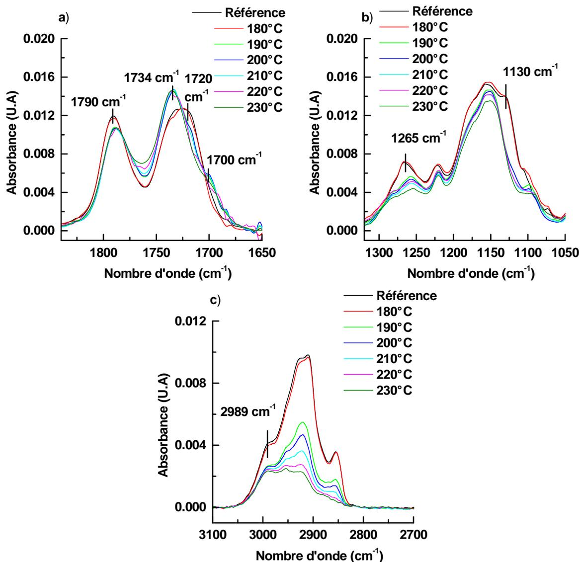
FIGURE V.10 – Spectres FTIR de la résine de référence exposée au traitement thermique pour a) la région entre  $1900\text{ cm}^{-1}$  et  $1650\text{ cm}^{-1}$  correspondant aux liaisons C=O et C=C b) la région entre  $1320\text{ cm}^{-1}$  et  $1050\text{ cm}^{-1}$  correspondant aux liaisons C-O-C et c) la région entre  $3000\text{ cm}^{-1}$  et  $2800\text{ cm}^{-1}$  correspondant aux liaisons C-H.
