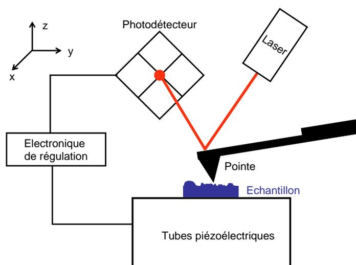
FIGURE II.5 – Principe général d'un microscope à force atomique.
