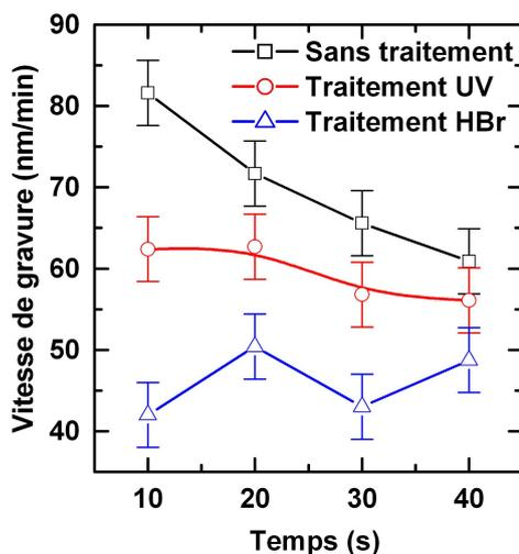
FIGURE IV.30 – Vitesses de gravure verticale des résines de référence et traitées par UV (30 s) et HBr (30 s) en fonction du temps de gravure.
