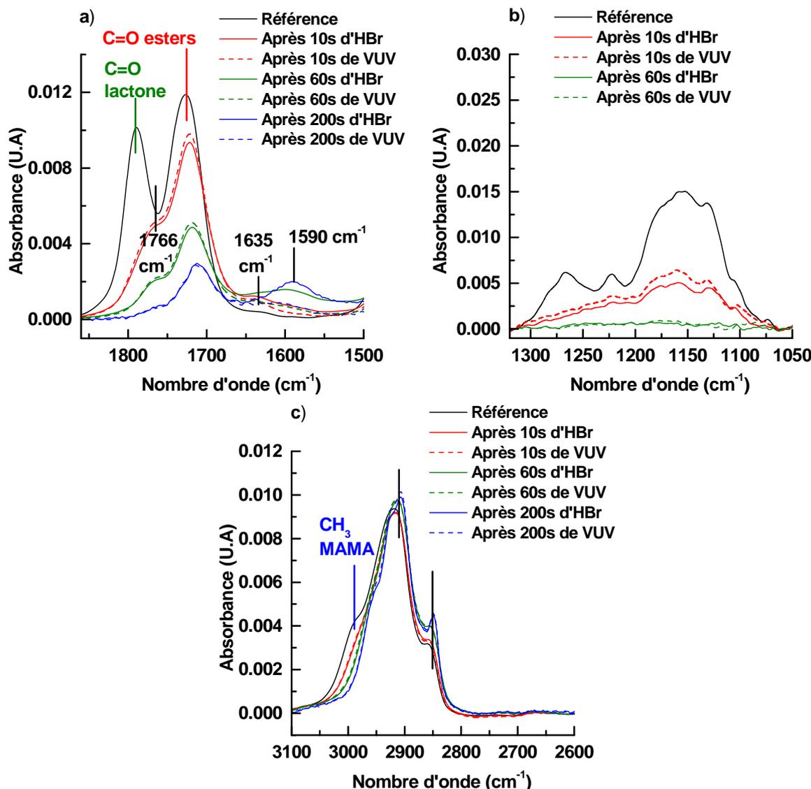
FIGURE IV.7 – Spectres FTIR de la résine 193 nm exposée aux traitements HBr et UV en fonction du temps pour a) la région entre 1900 cm<sup>-1</sup> et 1550 cm<sup>-1</sup> correspondant aux liaisons C=O et C=C, b) la région entre 1320 cm<sup>-1</sup> et 1050 cm<sup>-1</sup> correspondant aux liaisons C-O-C et c) la région entre 3000 cm<sup>-1</sup> et 2800 cm<sup>-1</sup> correspondant aux liaisons C-H.
