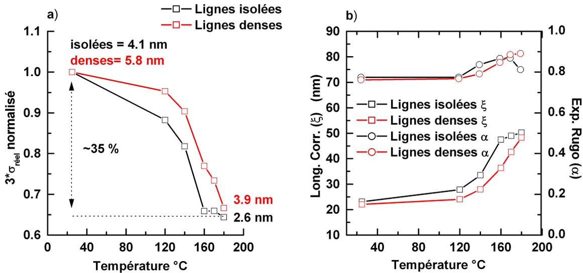
FIGURE V.20 – Evolution a) du LWR normalisé et b) de la longueur de corrélation ( $\xi$ ) et de l'exposant de rugosité ( $\alpha$ ) de la résine exposée aux "UV" du plasma Ar, en fonction de la température de recuit.
