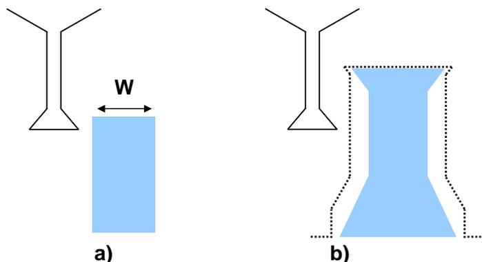
FIGURE II.10 – Motifs étalon de qualification de pointe : a) VPS et b) IFSR .
