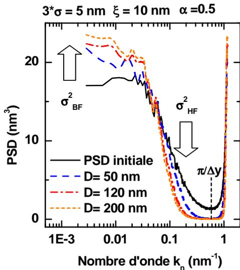
FIGURE III.16 – PSD d'un profil de rugosité obtenu grâce à la simulation (courbe noire). PSD du même profil vu par différents diamètres de pointe (courbes bleue, rouge et orange). L'axe  $y$  a été représenté en échelle linéaire afin de mieux distinguer les courbes dans le domaine des basses fréquences.
