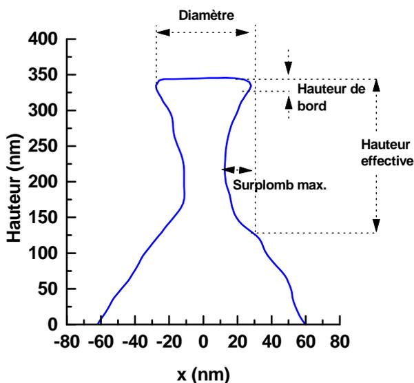
FIGURE II.11 – Reconstitution du profil d'une pointe de mesure.
