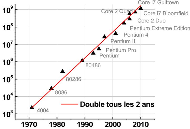
FIGURE I.1 – Evolution du nombre de transistors dans les processeurs d’Intel.
