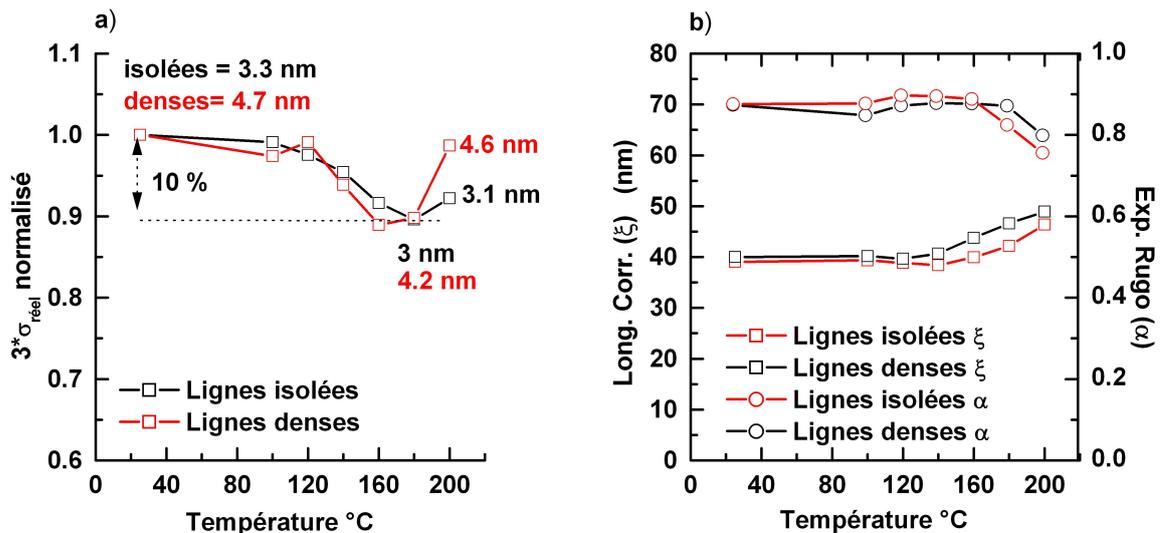
FIGURE V.13 – Evolution a) du LWR normalisé et b) de la longueur de corrélation ( $\xi$ ) et de l'exposant de rugosité ( $\alpha$ ) du motif de résine exposée aux UV du plasma HBr, en fonction de la température de recuit.
