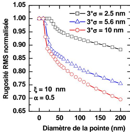
FIGURE III.14 – Evolution de la rugosité normalisée ( $\sigma_{\Phi}/\sigma$ ) en fonction du diamètre de la pointe pour différentes valeurs de  $\sigma$ . Les valeurs de  $\xi$  et de  $\alpha$  sont respectivement fixées à 10 nm et 0.5.
