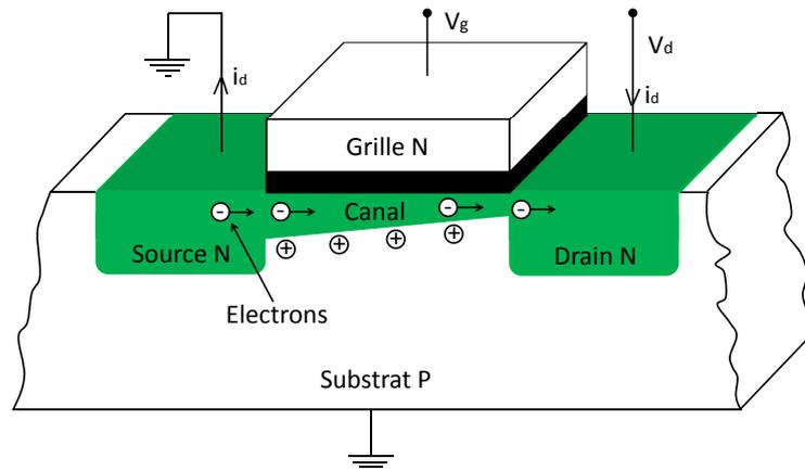
FIGURE I.2 – Schéma de la structure d'un transistor nMOS, en régime de fonctionnement linéaire.
