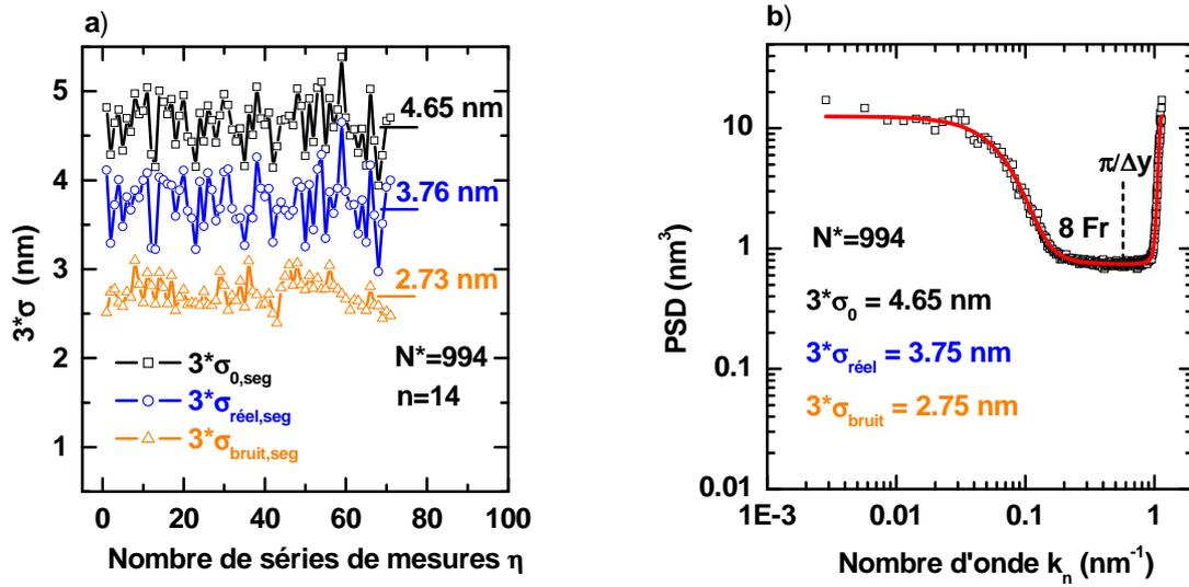
FIGURE III.29 –  $3\sigma_0$ ,  $3\sigma_{réel}$  et  $3\sigma_{bruit}$  obtenus le long de la ligne de silicium avec la méthode a) d’alignement et b) d’ajustement de PSD. L’acquisition CD-SEM est effectuée à 8 frames d’intégration et le nombre total d’images est 994 ( $N^*$ ). Les 71 séries de mesures ( $\eta$ ) sont effectuées à différents endroits de la ligne, et chacune est constituée de 14 mesures prises au même endroit.
