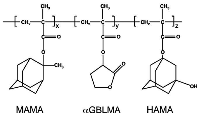
FIGURE I.18 – Structure chimique d'une résine 193 nm constituée du groupement méthyle adamantane (MAMA), du groupement lactone ( $\alpha$ GBLMA) et du groupement polaire (HAMA).
