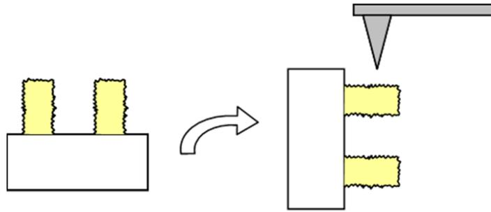
FIGURE I.27 – Schéma de la technique AFM utilisée par Goldfarb *et al.* [61] et Yahata *et al.* [60].
