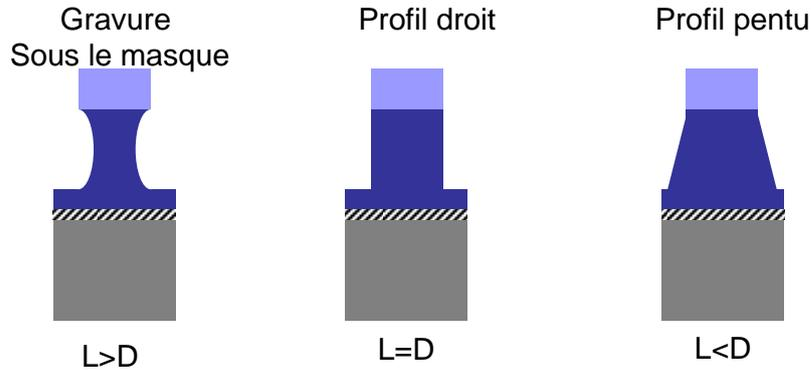
FIGURE I.25 – Influence de la vitesse de dépôt et de la vitesse de gravure latérale sur les profils de gravure.
