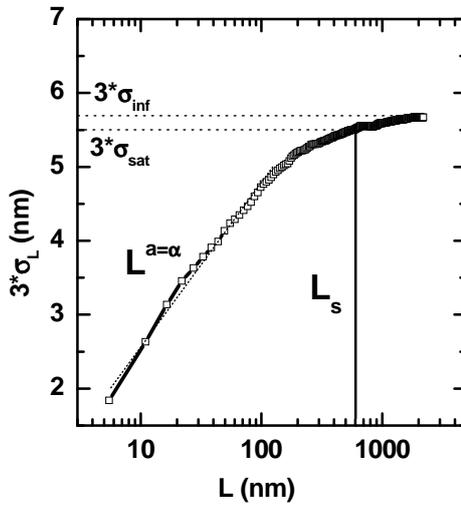
FIGURE III.2 – Evolution de la rugosité RMS avec l'échelle d'observations (obtenues à partir du LER d'une ligne de résine 193 nm mesurée au CD-SEM).
