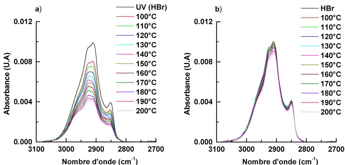
FIGURE V.17 – Spectres FTIR entre  $3000\text{ cm}^{-1}$  et  $2800\text{ cm}^{-1}$  correspondant aux liaisons C-H pour des résines exposées a) aux UV du plasma HBr et b) au plasma HBr dans son intégralité à différentes températures de recuit.
