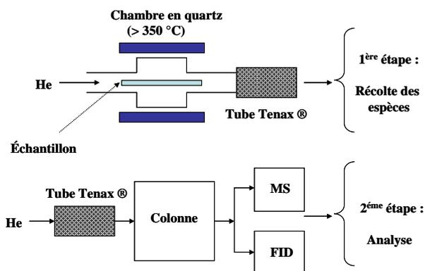
FIGURE IV.15 – Schéma du dispositif expérimental des analyses chromatographiques
