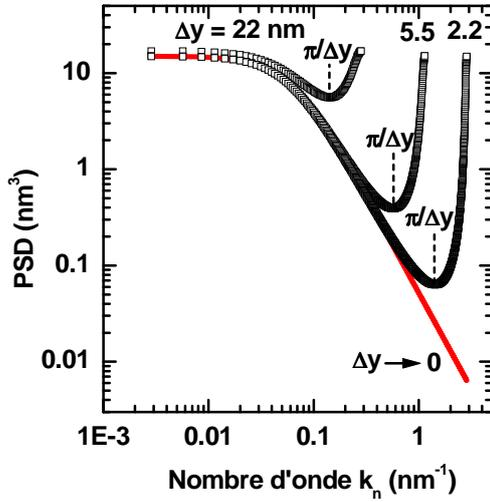
FIGURE III.4 – Représentation des PSD discrètes et continues obtenues à l'aide des équations III.18 et III.19 pour différentes valeurs de l'intervalle  $\Delta y$ . Les valeurs de  $3\sigma$ ,  $\xi$ , et  $\alpha$  sont respectivement fixées à 5 nm, 17 nm et 0.5.
