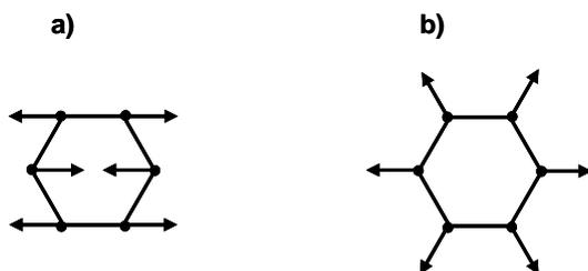
FIGURE IV.12 – Modes vibrationnels a) G et b) D des atomes de carbone
