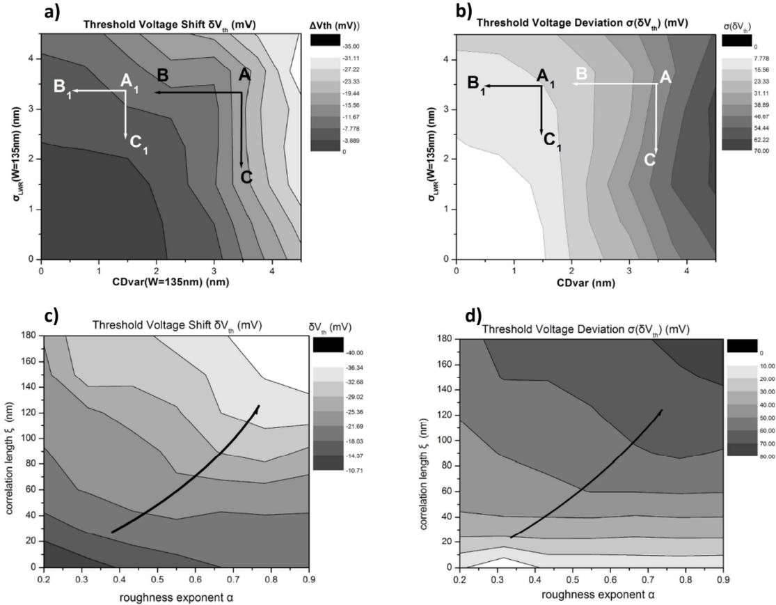
FIGURE I.9 – a) et b) Impact du LWR, CDvar et c) et d) de la longueur de corrélation ( $\xi$ ), de l'exposant de rugosité ( $\alpha$ ) sur la tension de seuil et ses fluctuations d'après Patsis et Constantoudis [14, 15].
