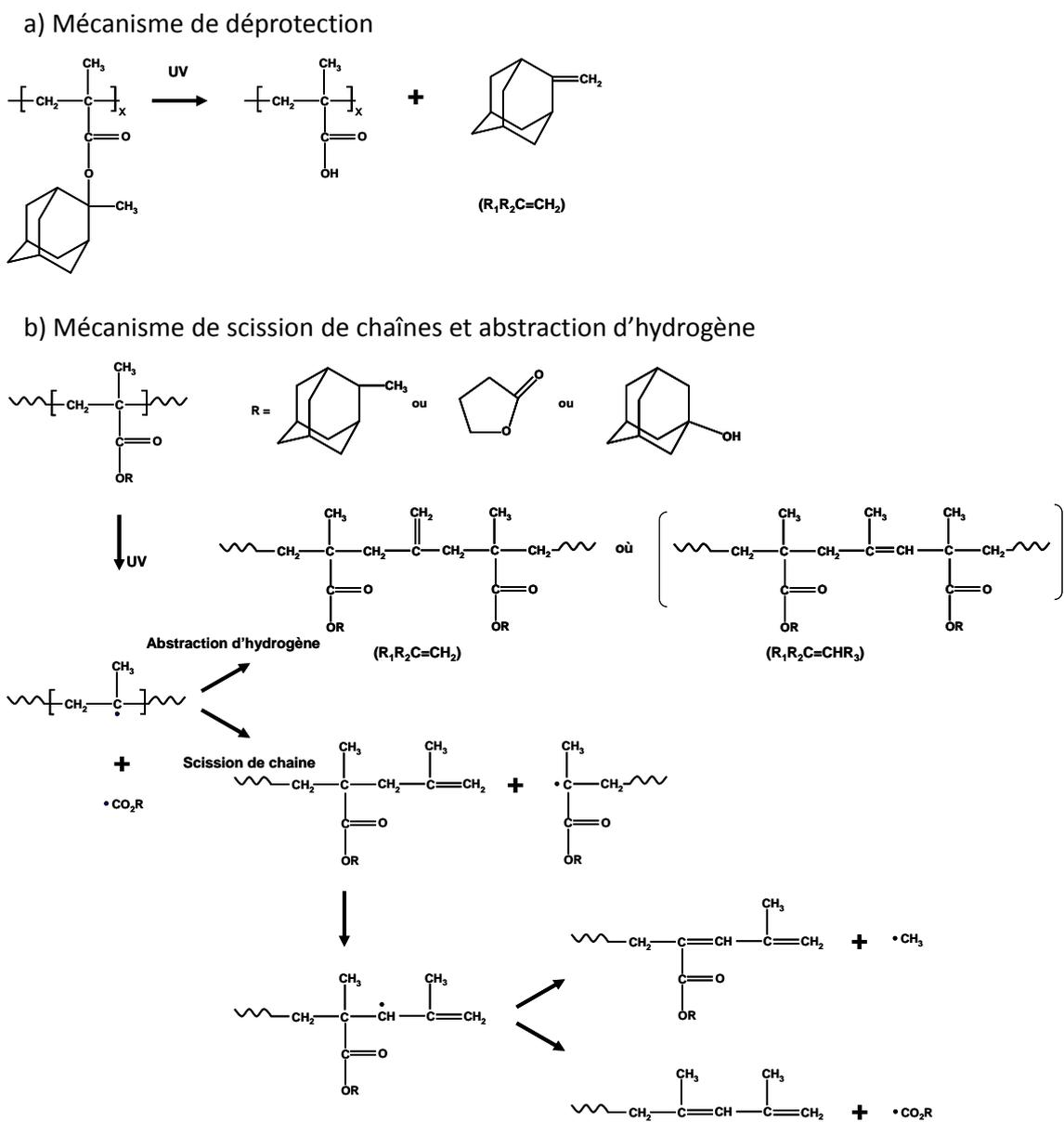
FIGURE IV.8 – Schéma de la formation de doubles liaisons C=C induite par les rayonnements UV du plasma.
