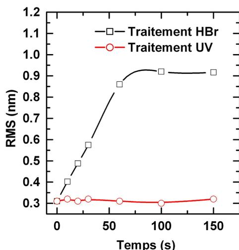
FIGURE IV.19 – Evolution de l'état de surface des résines exposées aux traitements HBr et UV.
