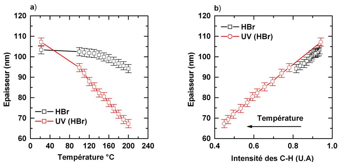
FIGURE V.18 – Evolution de l'épaisseur des résines traitées par HBr et les UV du plasma HBr a) en fonction de la température et b) en fonction de l'intensité intégrée des pics de la région C-H des spectres FTIR de la Fig. V.17.
