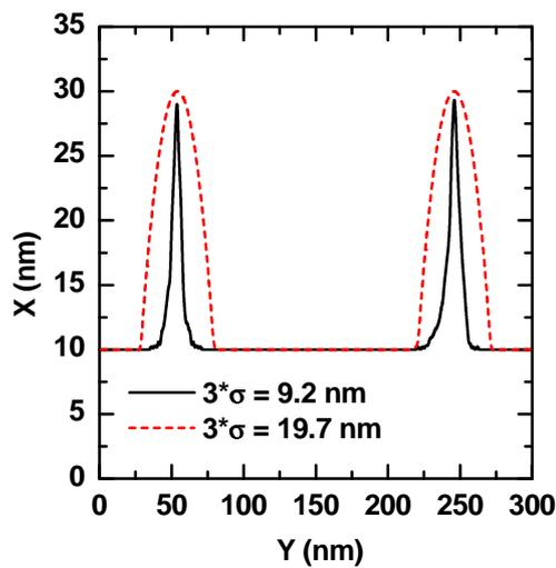
FIGURE III.17 – Illustration des "pics de Dirac" avant (courbe noire) et après (courbe rouge) convolution par une pointe de diamètre de 120 nm.
