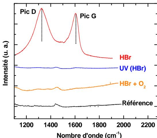
FIGURE IV.11 – Spectre Raman (Région 1100-1700  $\text{cm}^{-1}$ ) des résines soumises au plasma HBr, aux UV et au plasma HBr suivi d'un plasma de  $\text{O}_2$ .
