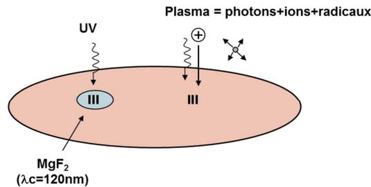
FIGURE IV.1 – Dispositif expérimental permettant de dissocier le rôle des UV de celui des espèces du plasma.
