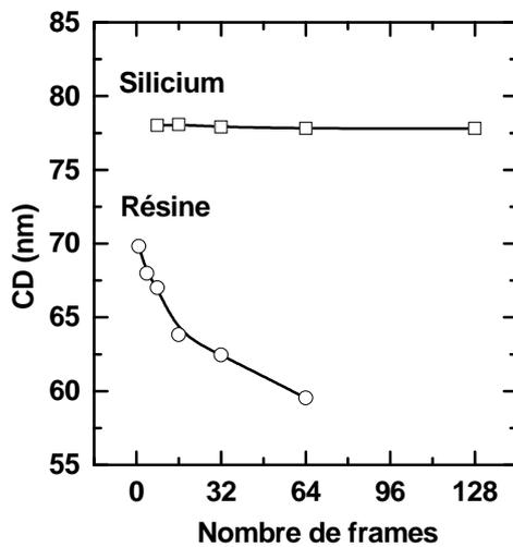
FIGURE III.18 – Evolution du CD d'une ligne de silicium et de résine en fonction du nombre de frames d'intégration.
