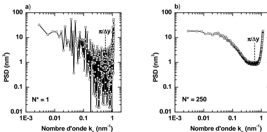
FIGURE III.6 – PSD expérimentales d'une ligne de résine obtenues avec le CD-SEM en moyennant a) une seule PSD et b) 250 PSD. La fenêtre d'observation ( $L$ ) et l'intervalle de mesure ( $\Delta y$ ) sont fixés à 2200 nm et 5.5 nm respectivement.
