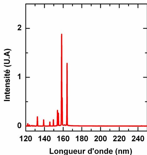
FIGURE IV.4 – Emission optique du plasma d'HBr.
