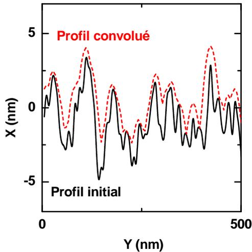
FIGURE III.13 – Allure typique d'un profil de rugosité obtenu par simulation (courbe noire). Le même profil a été convolué par un cercle de diamètre de 120 nm (courbe rouge).
