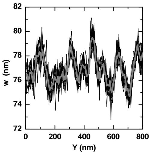
FIGURE III.24 – Profils de rugosité de la largeur de lignes obtenus à l'aide du CD-SEM sur silicium. Les courbes noires représentent 14 profils obtenus au même emplacement et la courbe grise représente la moyenne des 14 mesures. Le LWR réel est estimé à partir de la courbe grise.
