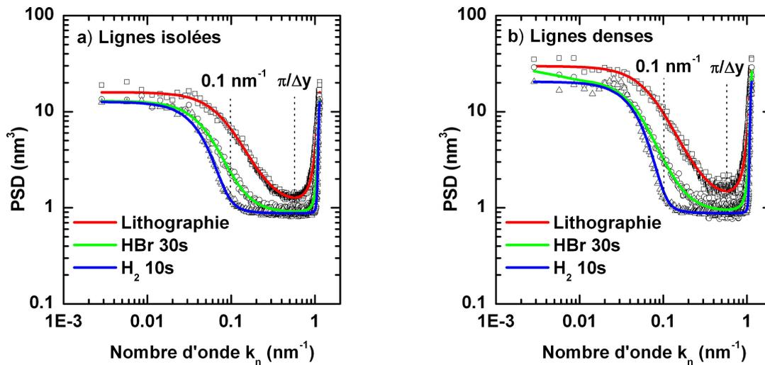
FIGURE V.4 – PSD expérimentales et théoriques obtenues après étape de lithographie, et après traitement HBr et H<sub>2</sub>, dans le cas a) des lignes isolées et b) des lignes denses.
