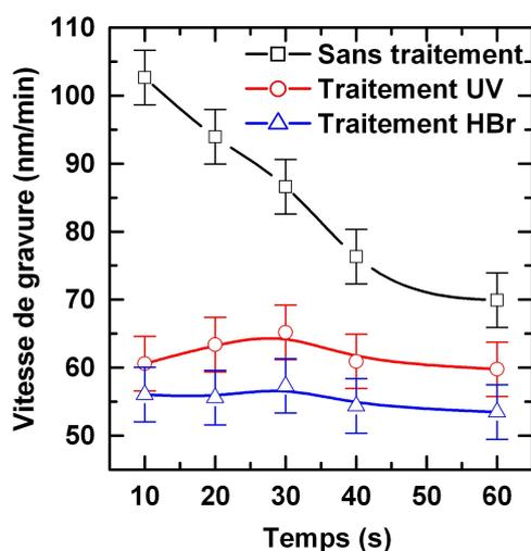
FIGURE IV.26 – Evolution de la vitesse de gravure des résines de référence et exposées à 30 s de traitements HBr et UV pendant l'étape de gravure Ar/CHF<sub>3</sub>/CF<sub>4</sub>.
