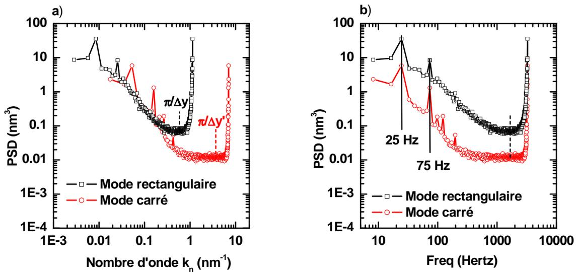
FIGURE III.39 – a) PSD expérimentales d’une ligne de silicium obtenues avec les modes de balayage rectangulaire et carré. b) L’axe  $x$  des mêmes PSD est représenté dans le domaine fréquentiel temporel.
