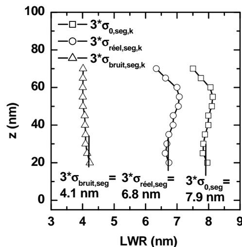
FIGURE III.35 – Dépendance à la hauteur du motif de  $3\sigma_{0,seg,k}$ ,  $3\sigma_{réel,seg,k}$  et  $3\sigma_{bruit,seg,k}$  obtenus à l'emplacement A' de la ligne de résine photosensible et déterminés par la méthode d'alignement au CD-AFM avant les mesures CD-SEM.
