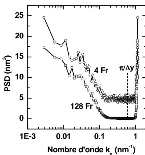
FIGURE III.9 – PSD expérimentales d'une ligne de silicium obtenues avec le CD-SEM pour un nombre de frames de a) 4 et b) 128. La fenêtre d'observation ( $L$ ) et l'intervalle de mesure ( $\Delta y$ ) sont respectivement fixés à 2200 nm et 5.5 nm. Chaque courbe est obtenue en moyennant 250 PSD.
