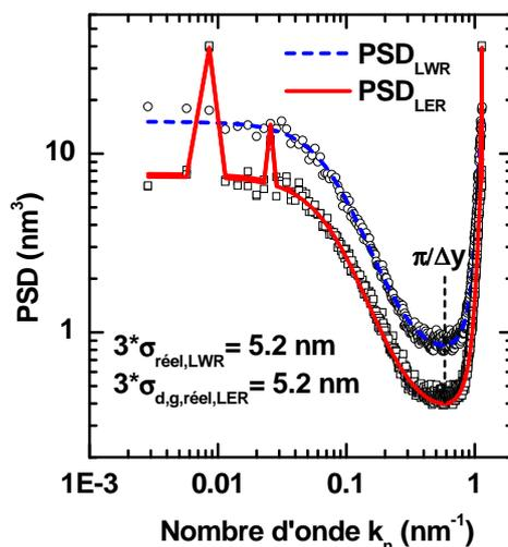
FIGURE III.42 – PSD expérimentales (carrés vides) et théoriques (lignes continues rouges) de LER à 4 frames d'intégration d'une ligne de résine. La PSD de LWR à 4 frames a été représentée pour comparaison (ligne en pointillés bleus).
