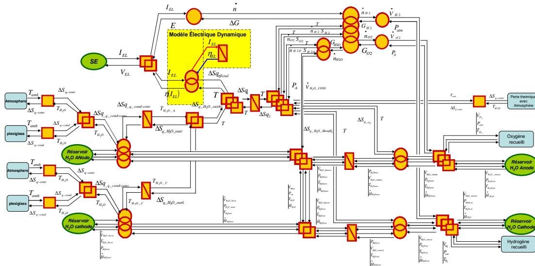
Figure 2- 45 : Prise en compte du modèle électrique dynamique dans le modèle REM global de l'électrolyseur
