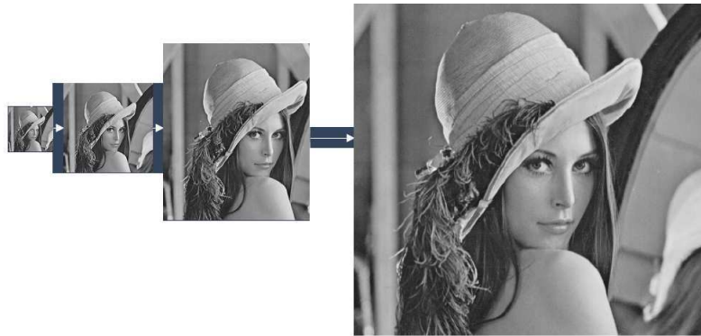
FIG. 1.4 – Transmission progressive par résolution
